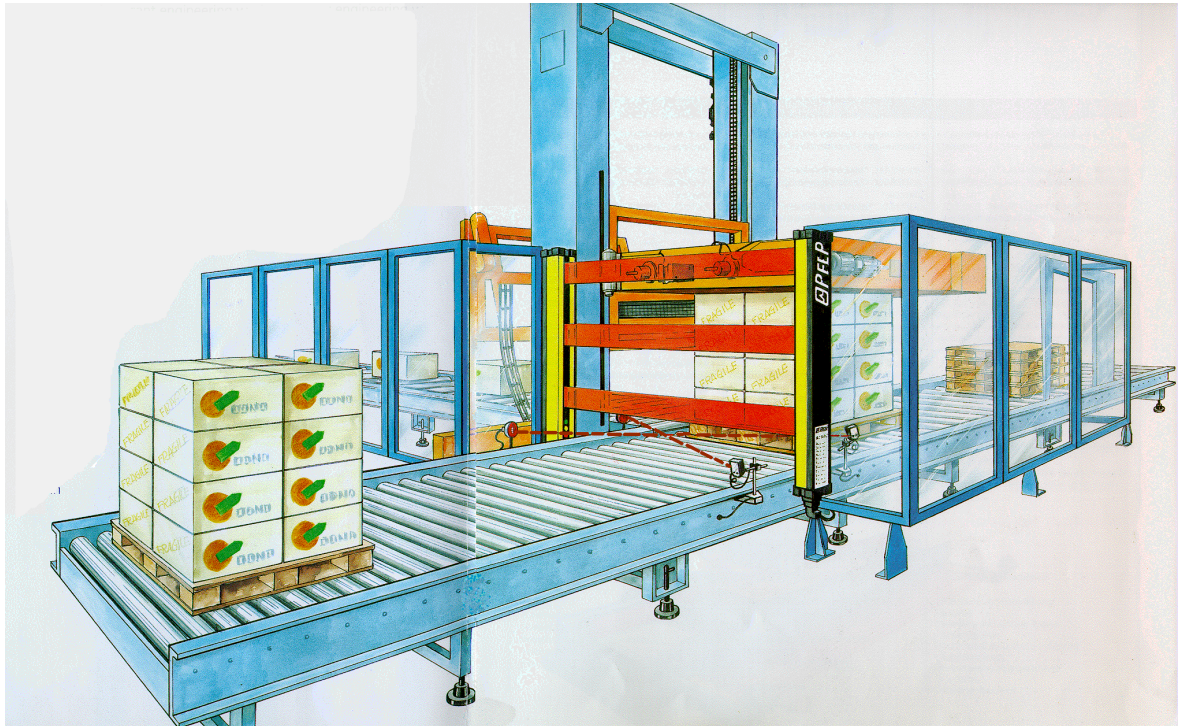
KUVIO 2. Kahden turvavyöhykkeen välinen valvonta passivoitavalla valoverholla (Sundcon Oy)
