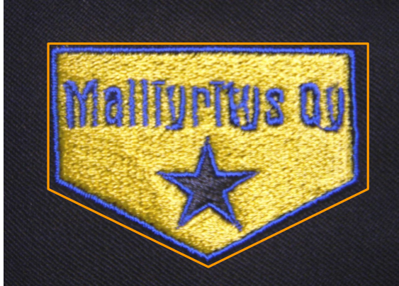
KUVIO 12. Toimikassidoksen aiheuttama vääristymä brodeerauksessa
