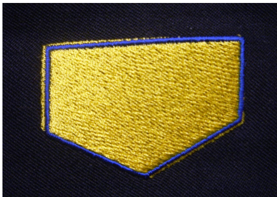
KUVIO 13. Brodeeraus toimikassidoksiselle kankaalle. Lihavoitusasetus maksimi 2,0 mm, joka on tässä tapauksessa liikaa, koska pohja-alue ei kohtaa reunustikkiä.
