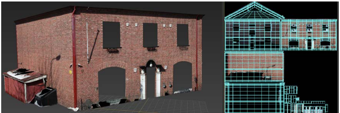
Kuvio 27. Vasemmalla tekstuuri on projisoitu fotogrammetriasovelluksen 3D-mallista uuteen yksinkertaisempaan geometriaan. Oikealla yksinkertaisemman mallin UV laatta, jossa tekstuurit ovat ortografisesti projisoituna ja seinät ovat selviä kokonaisuuksia toistensa vieressä.
