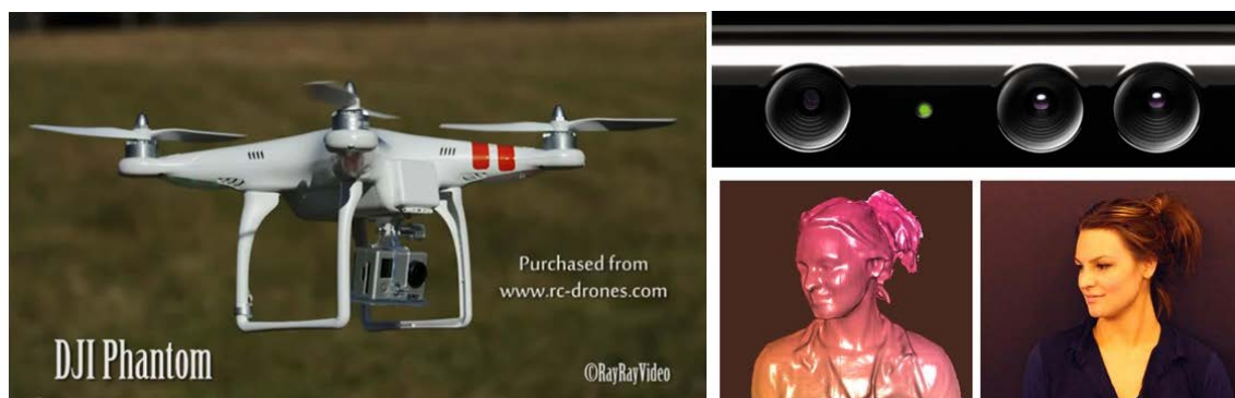
Kuvio 41. Vasemmalla noin 1000 euroa maksava kauko-ohjattava helikopteri, jolla ylhäältä päin kuvaaminen tulee halvemmaksi. Oikealla Microsoft Kinect ja Kinetic Fusionilla realiajassa luotu 3D-malli valokuvasta.
