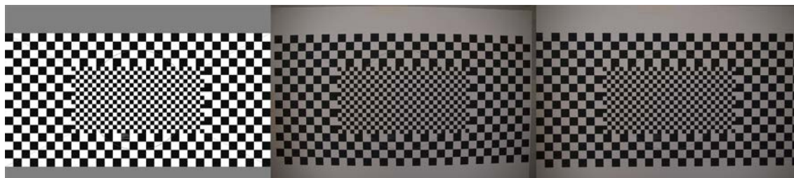
Kuvio 3. Lens Distortion Grid -ruudukko, jonka avulla saadaan tietoon kameran ja objektiivin muodostama linssivääristymä. Vasemmalta: Alkuperäinen kuva tiedostona, keskellä A3:lle tulostettu kuva järjestelmäkameralla kuvattuna ja viimeisenä sama kuvankäsittelyohjelmassa korjattuna. Näin saaduilla asetuksilla korjataan varsinaiset talosta otetut kuvat.
