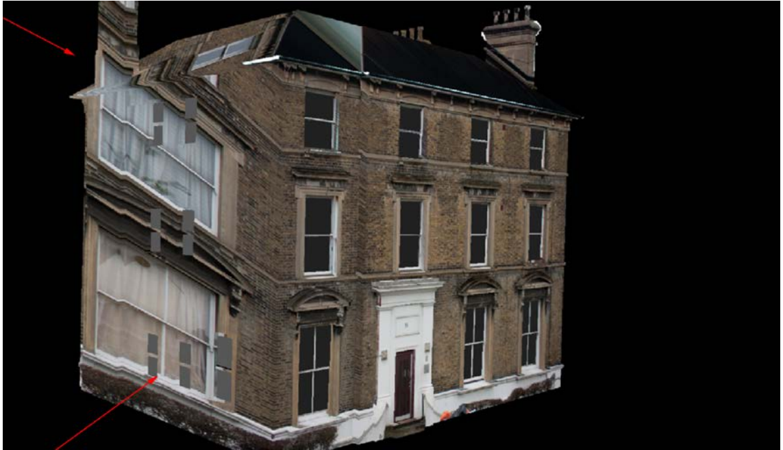
Kuvio 10. Edestäpäin otettu kuva talosta on projisoitu talon pintaan vastaavan 3D-kameran kautta. Talon sivuilla ja takana ja katolla tekstuuri projisoituu vain läpi, mutta talon etuosaan saamme jo varsin toimivan tekstuurin.
