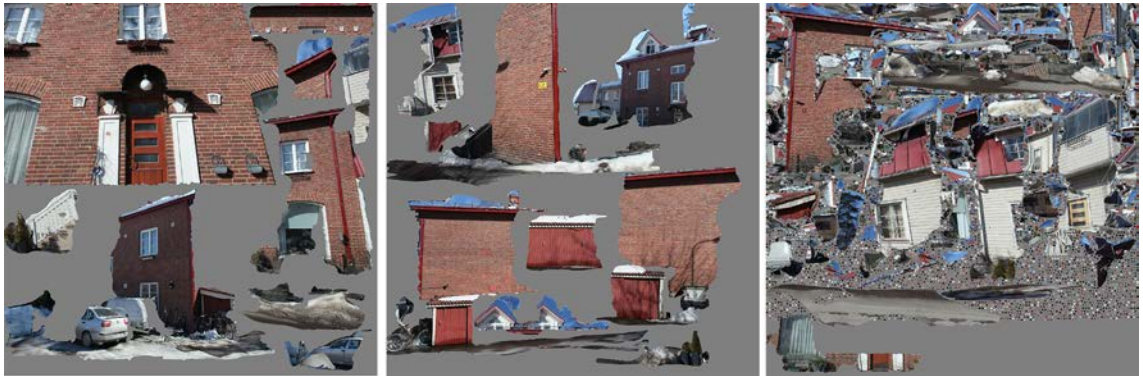
Kuvio 26. Autodesk 123D Catch -ohjelman luomat UV laatat eivät suurempia riemunkiljahduksia aiheuta. Optimitilanteessa laattoja olisi vain yksi, tekstuurit olisivat mahdollisimman yhtenäiset ja projisoituna suoraan edestäpäin, silloin niitä olisi helppo kuvankäsittelyohjelmassa vielä jälkikäsiellä.
