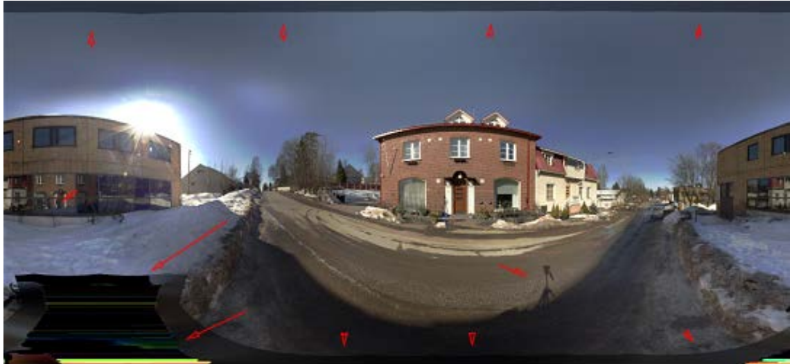
Kuvio 34. 37 HDR-kuvasta poistettiin kromaattinen aberraatio ja ne yhdistettiin panoraamaohjelmassa equirectangular projektioksi (kuvassa). Kuvan ylä- ja alalaidassa näkyy mustaa, koska kuvatessa ei saatu katettua aivan koko 360°180 asteen palloa. Otetuissa kuvissa pitää aina olla myös noin kolmasosa samaa kohtetta kuin edellisessä kuvassa, jotta panoraamaohjelma osaa yhdistää ne toisiinsa vastaavien pisteiden avulla kuin mitä edellä mainitut fotogrammetriaohjelmatkin käyttävät.
