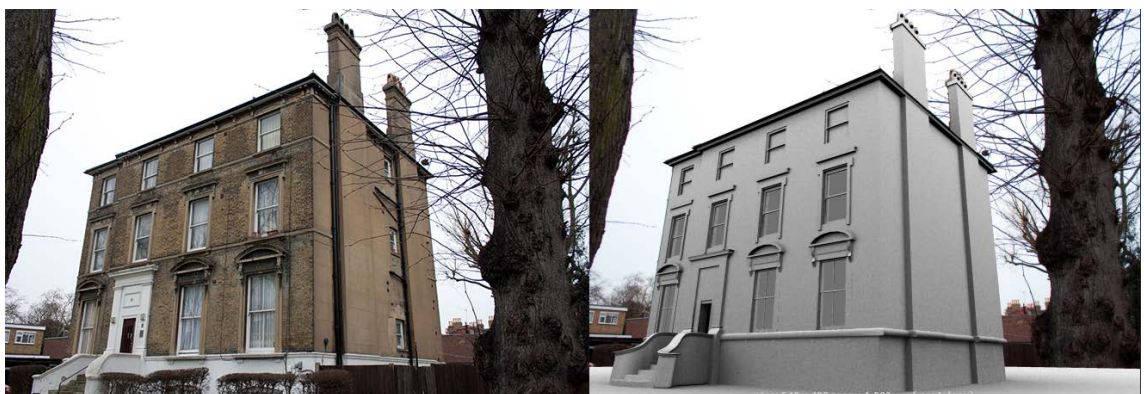
Kuvio 9. Vasemmalla alkuperäinen kuva. Oikealla 3D-malli renderöitynä Ambient occlusion shaderilla. Näin saadaan jo hyvä kuva mallin ulkonäöstä. Virheet geometriassa näkyvät myös helpommin mallin pinnassa ennen varsinaista valaistusta ja teksturointia. Virheet esiintyvät usein tummentumina väärissä paikoissa.
