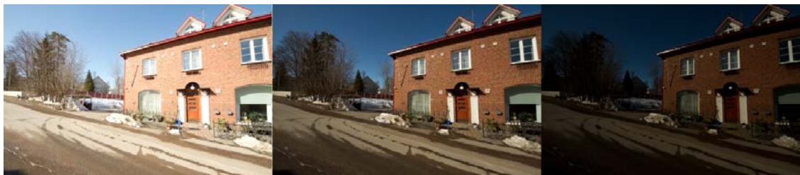
Kuvio 32. HDRI-kuva muodostettiin ottamalla täysin samasta kohtaa kolme kuvaa eri valotusajoilla jotka tässä tapauksessa olivat vasemmalta 1/50s, 1/200s, 1/800s.
