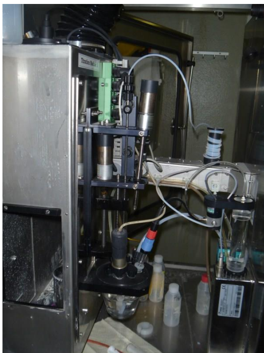
KUVA 2. KO-9128 alkalianalysaattorin näytteen analysointi.
