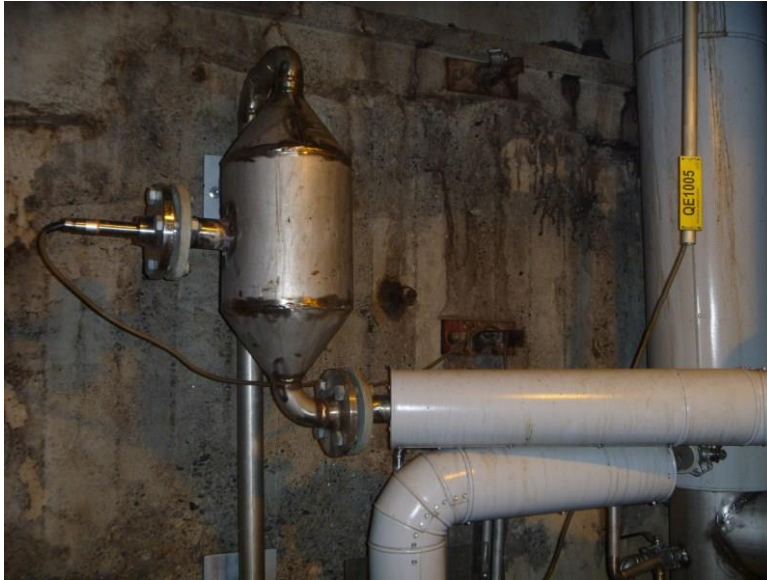
KUVA 4. QI1005 paisunnan jäännösalkalin anturi.
