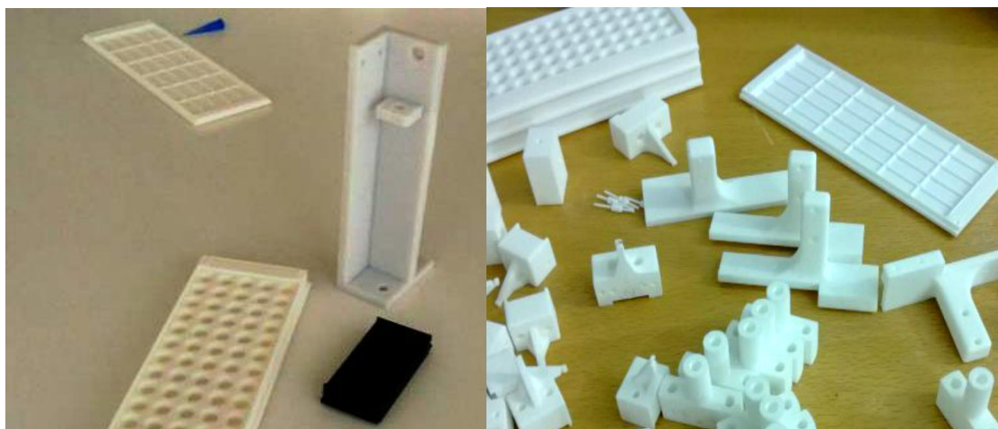
Kuva 15. 3D-tulostimella tehtyjä kappaleita. Musta on tehty muovilangalla, valkoiset tasoittain sintraamalla.
