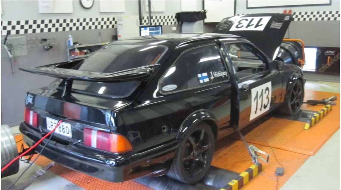
Kuva 6. Sierra AMW Dyno Servicellä kiinnitettynä alustadynamometriin.
