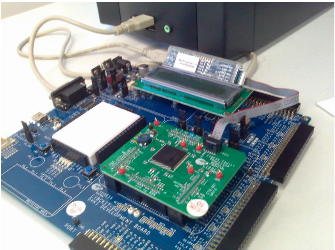
KUVA 1. CY8CKIT-001 PSoC Development Kit käyttövalmiina
