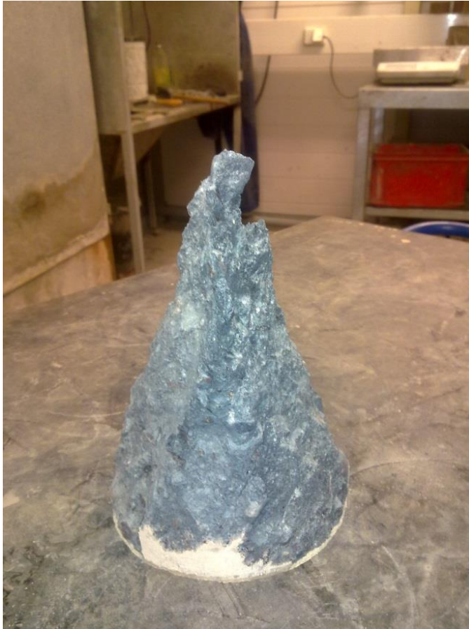
Kuva 1: Halkaistu vihreä betoni koekappale.
