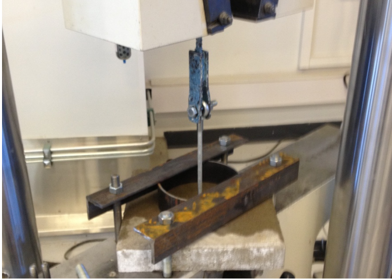
KUVA 10. Kohtisuoran vedon tuenta ja nivelellinen kiinnitys
