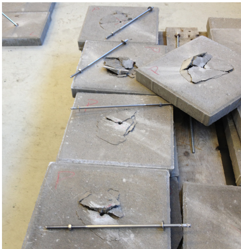
KUVA 13. Murtoon asti puhdistettuihin porareikiin asennetut Kalm KDK-UE A4 M8 ankkurit
