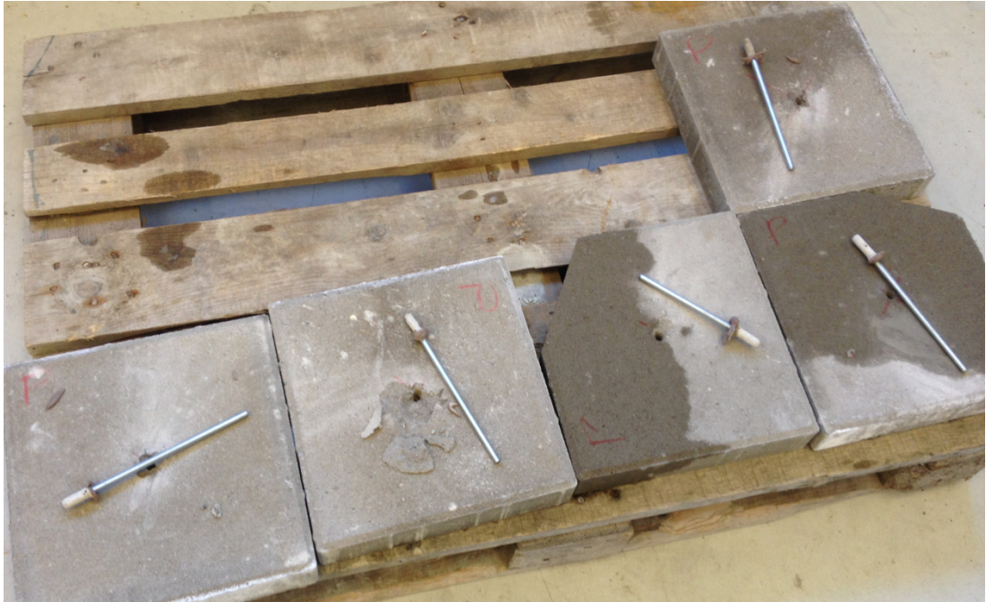
KUVA 16. Murtoon asti kuormitetut Hilti HIT-HY 200-A + HIT-V-R M8 ankkurit
