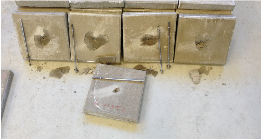
KUVA 15. Murtoon asti 45°:n kulmaan asennetut Kalm KDK-UE A4 M8 ankkurit
