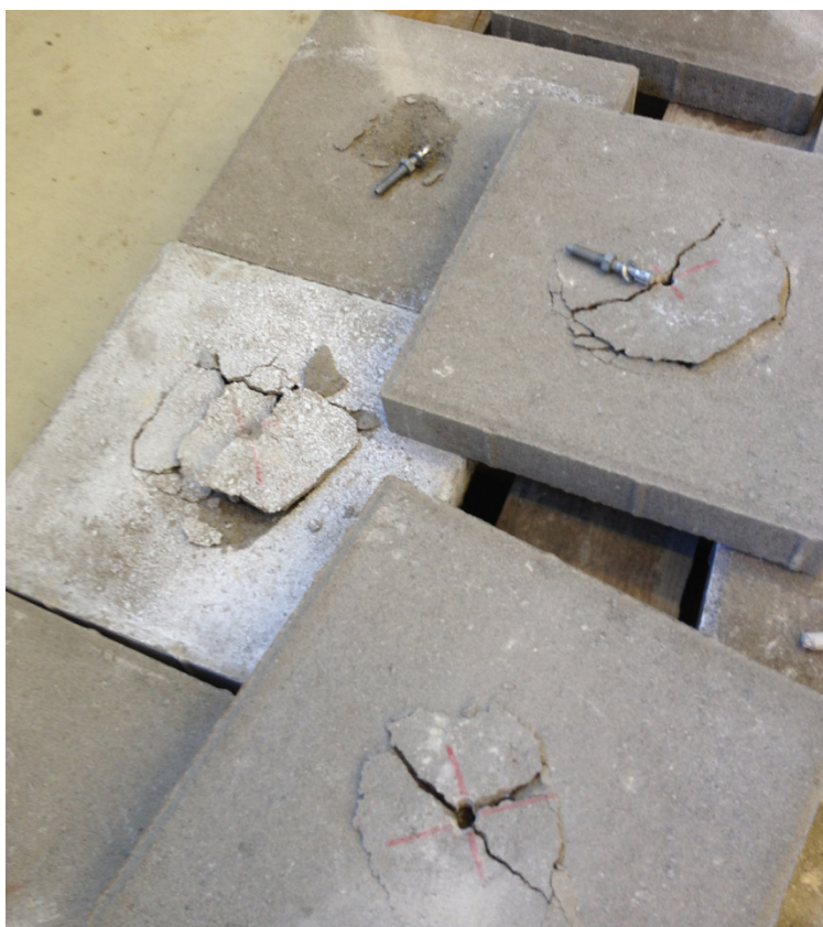
KUVA 12. Murtoon asti kuormitetut Sormat S-KAK M8x52 -ankkurit
