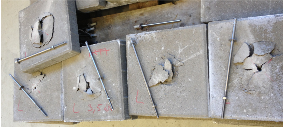
KUVA 14. Murtoon asti puhdistamattomiin porareikiin asennetut Kalm KDK-UE A4 M8 ankkurit
