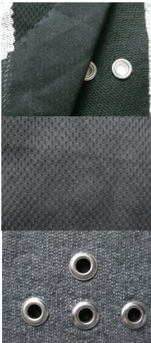
KUVA 29 Sirkkojen taakse asetettu Coolmax-kangas peittää estäen läpinäkyvyyden ja hengittää. Valokuvat Sanni Anttila 2013.
