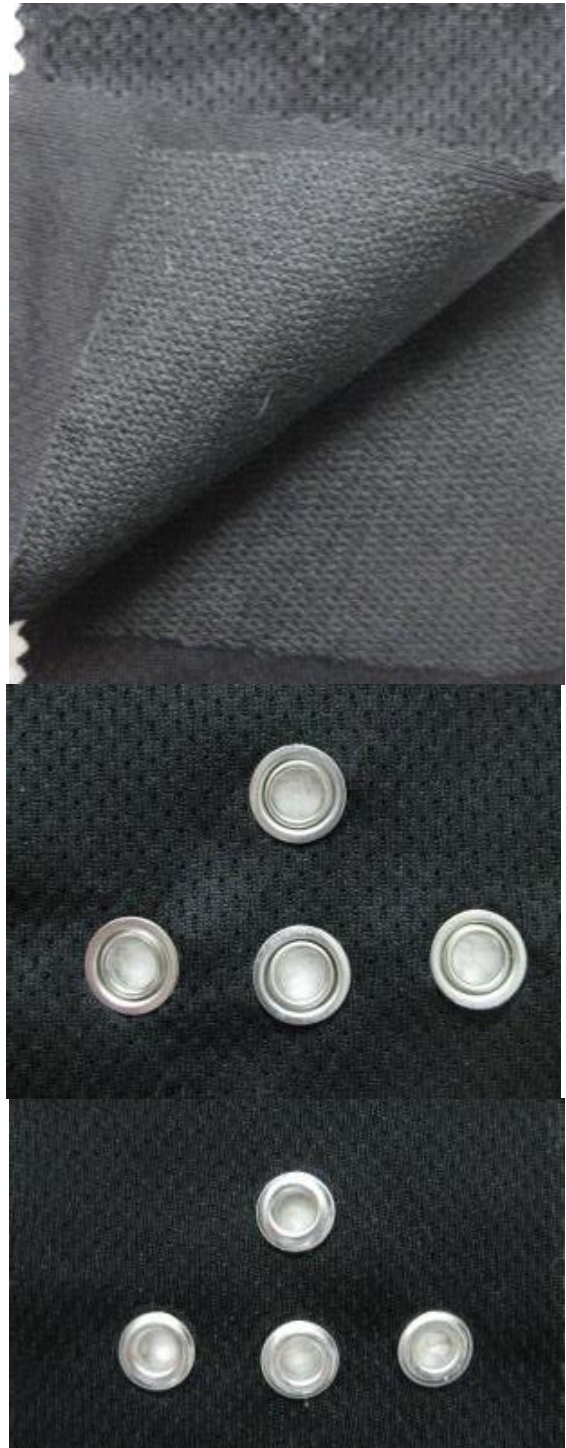
KUVA 30. Venttiili toteutettuna kaksinkertaiseen tuettuun Coolmax- kankaaseen. Valokuvat Sanni Anttila 2013.
