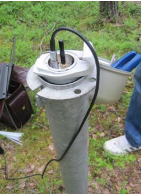
Kuva 10: GSM 2 tiedonsiirron ohjelmointi maastossa. (Noora Kuossari, 2012)
