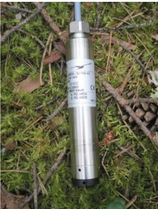
Kuva 11: Keller PAA-36XW -pinnankorkeusanturi. (Noora Kuossari, 2012)
