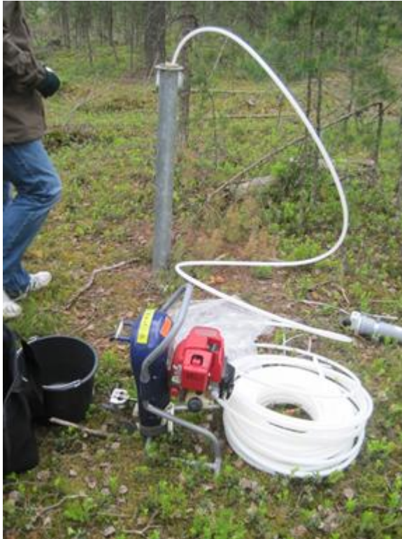
Kuva 9: Pohjaveden pumppaus havaintoputkesta 171. (Noora Kuossari, 2012)
