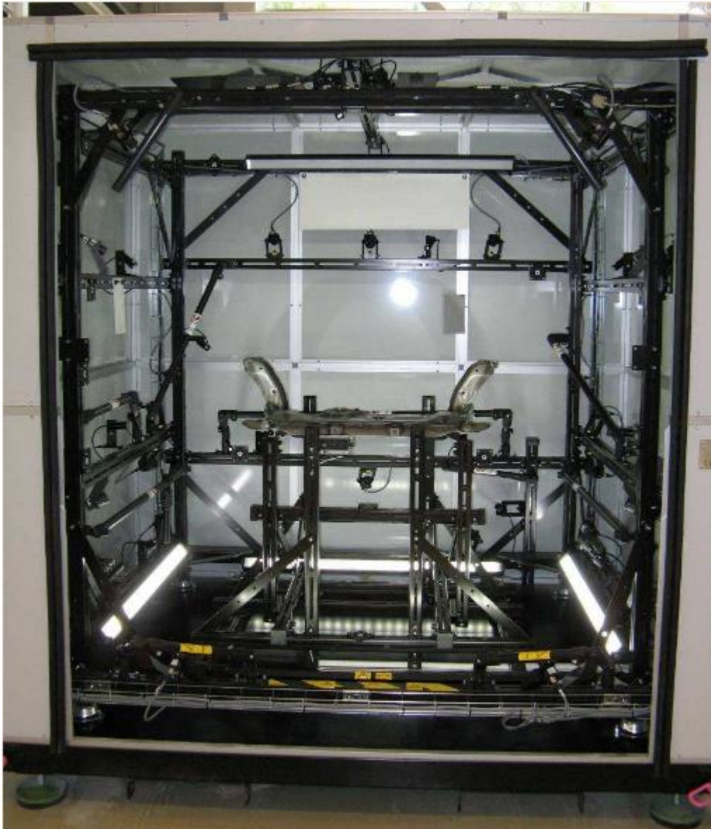
Kuva 9. Kuva mittausyksikön sisältä, jossa näkyy käytettävät kamerat ja valaistus (Aalto 2010).
