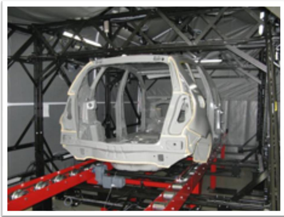
Kuva 10. Autonkorin mittaaminen Mapvision quality gate 6200 sarjan laitteella (Tekes 2013).
