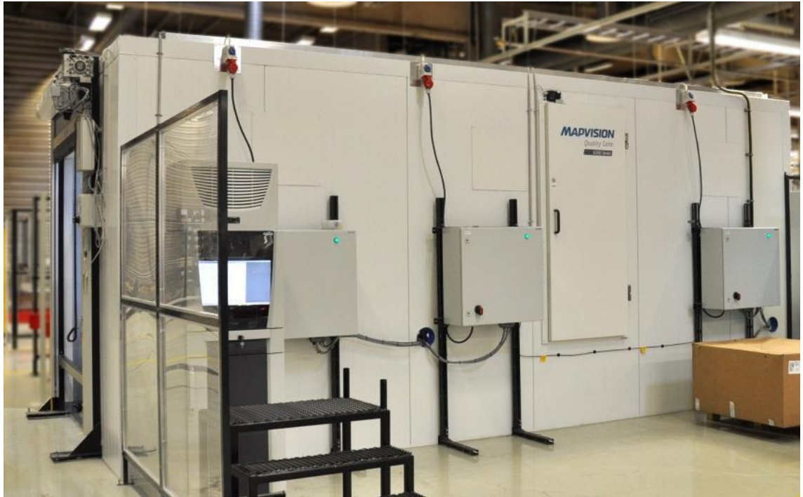
Kuva 8. Mapvision quality gate 6200 sarjan mittausyksikkö suurille kappaleille (Mapvision 2013).
