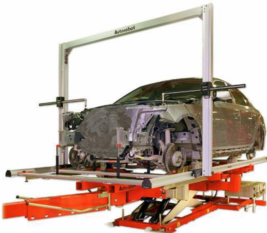
KUVA 20. Autorobotin mekaaninen mittalaite (24, s. 19)
