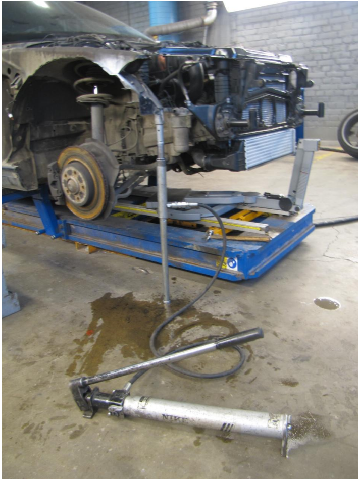
KUVA 31. Hydraulitunkilla pyöränkotelon oikaisua
