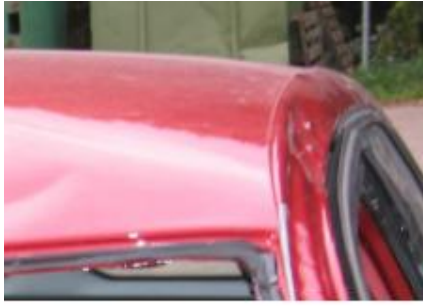
KUVA 6. VW Polon kattopellin ja sivupaarteen laserjuottosauma (7, s. 19)
