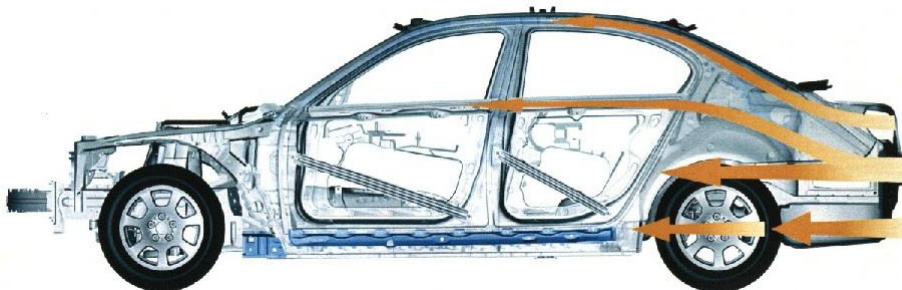
KUVA 16. BMW e60:n perätörmäyksen voimien jakautuminen (16, s. 38)
