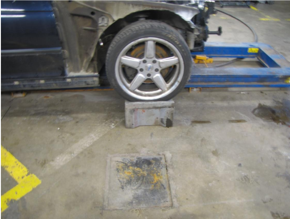
KUVA 25. Rullilla varustettu pukki, jonka päälle eturenkaat ajettiin.
