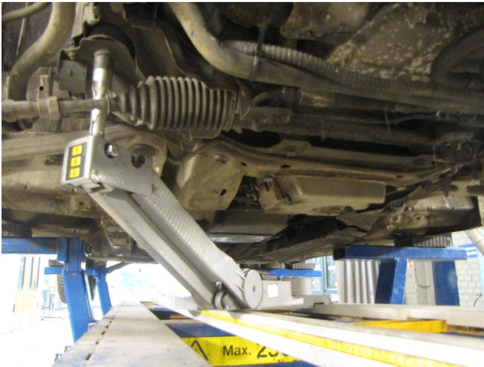
KUVA 26. Car-O-Tronic Vision Classic -mittalaite
