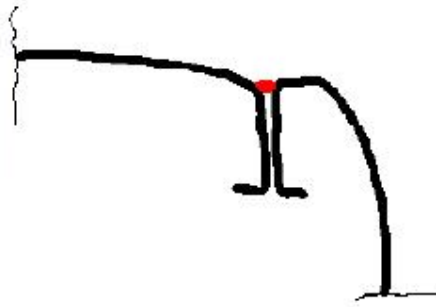
KUVA 6. VW Polon kattopellin ja sivupaarteen laserjuottosauma (7, s. 19)
