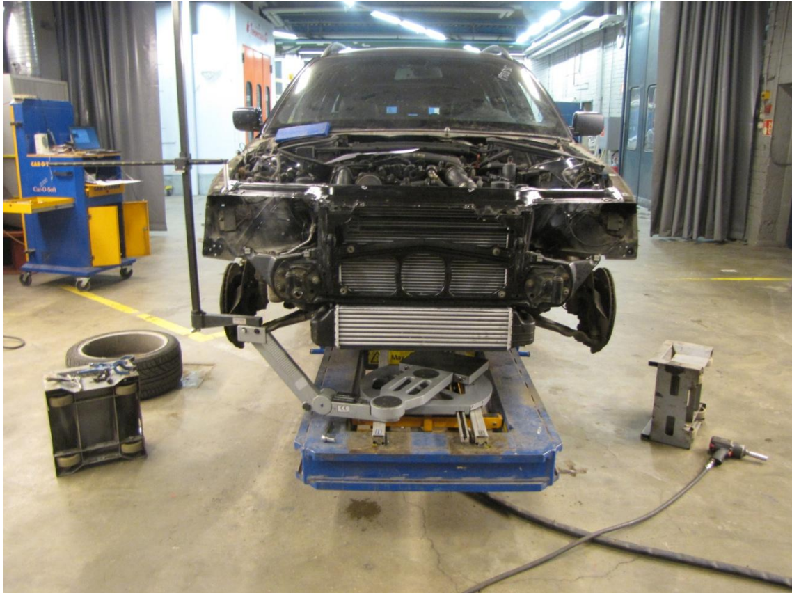
KUVA 28. Car-O-Tronic Vision Classic -mittauslaitteisto, jossa on yläpuolisiin mittauksiin tarkoitettu mittavarsi kiinni
