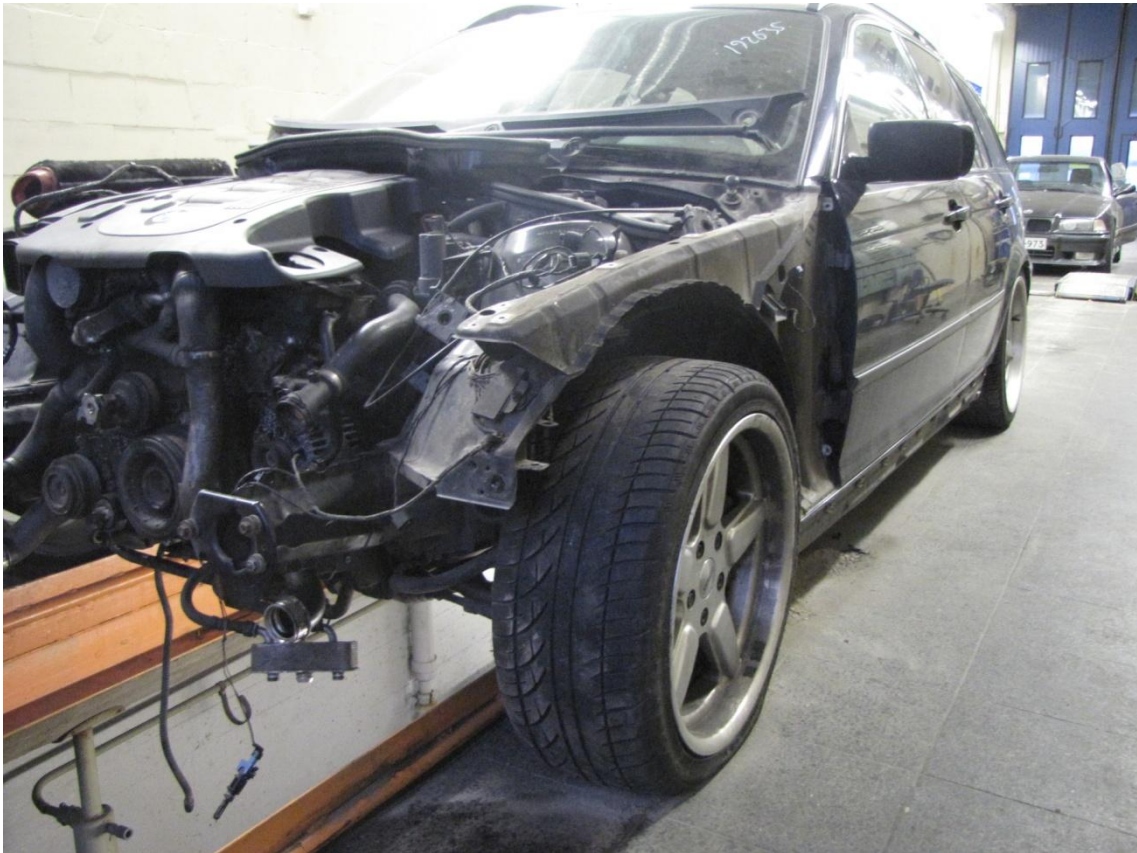
KUVA 24. Kaikki vaurioituneet osat poistettuna
