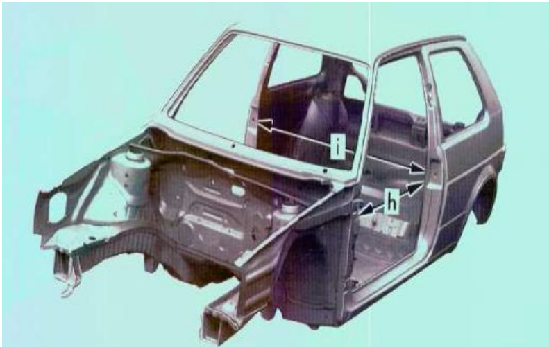
KUVA 11. Sekarakenteinen korirakenne (7, s. 1)
