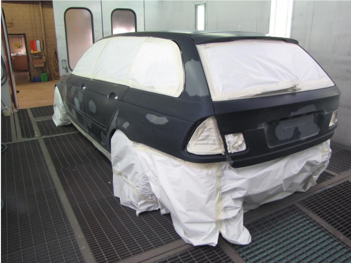
KUVA 32. Pohjustutyöt valmiina ja auto suojattu maalausta varten
