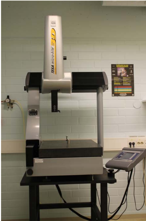
TESA micro-hite 3D koordinaattimittalaite
