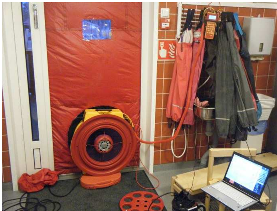
Kuva 1. BlowerDoor, puhallin ja tietokone asennettuna
