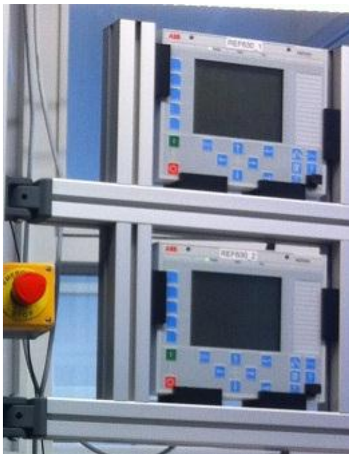
Kuvio 13. Ohjaavien releiden LHMI:t asennettuna testikaapin kylkeen.
