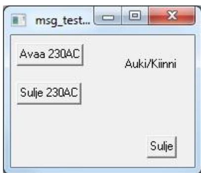
Kuvio 24. Releen kontaktin tilan vaihtaminen SCIL-ohjelmalla.
