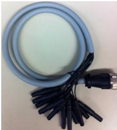
Kuvio 2. Projektissa käytetty testijohto, jossa on 12-pinninen UTG-liitin.
