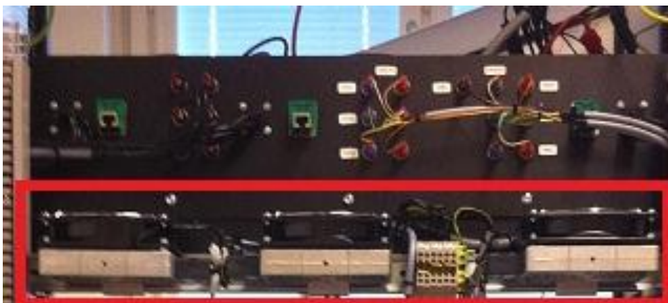
Kuvio 10. Testikaapin lämmittimet on asennettu ensimmäisen hyllyrivin takaosaan.
