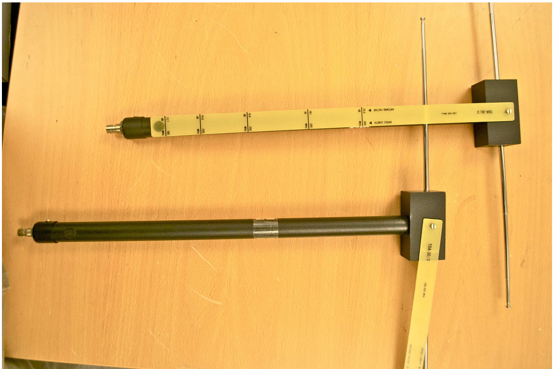
Kuva 3. 250 - 300 MHz:n taajuuksilla käytetyt dipoliantennit
