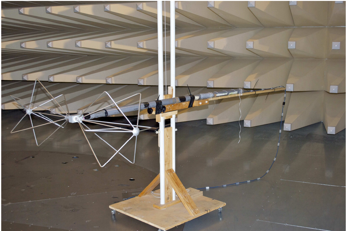
Kuva 5. Mittauksissa käytetty kaksoiskartioantenni
