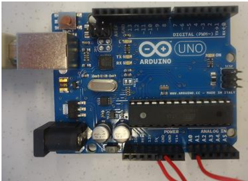
KUVA 7. Arduino ja siihen liitetyt johtimet paineanturilta
