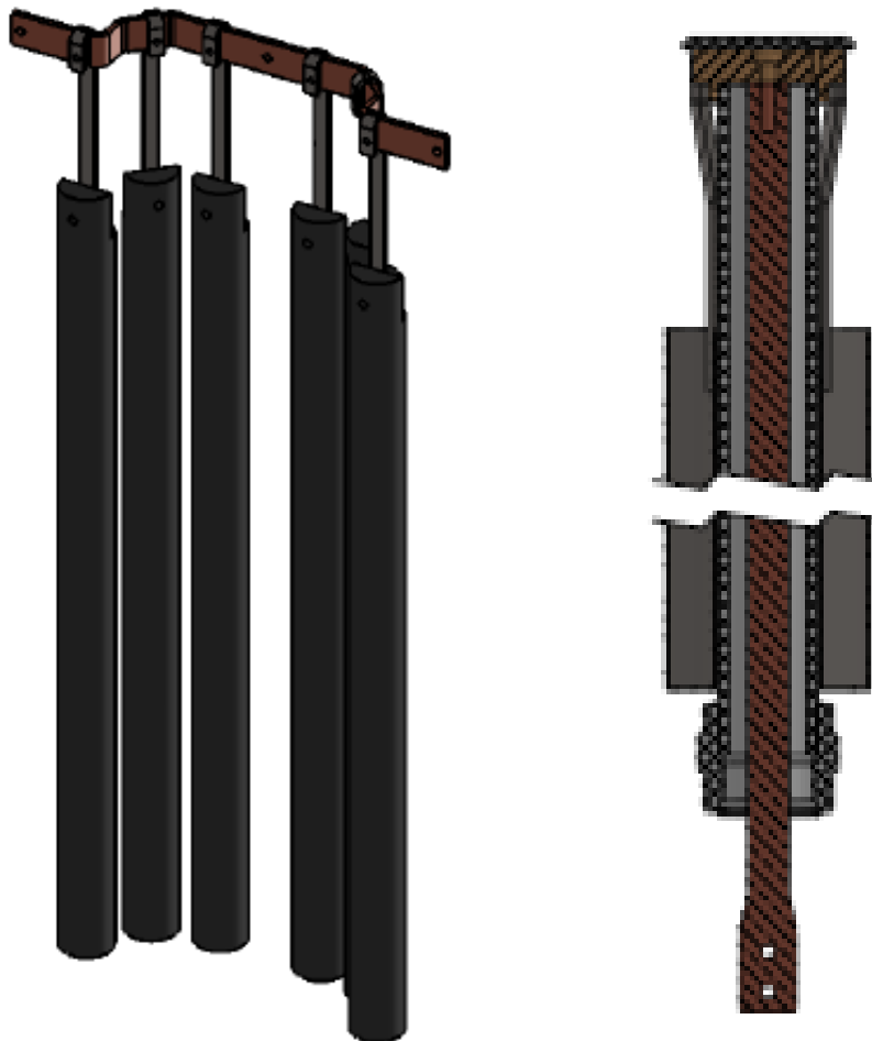
KUVA 9. Reuna-anodit ja keskianodin poikkileikkaus
