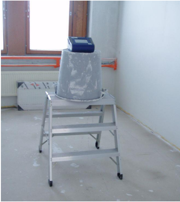
KUVIO 6. Ilman hiukkaspitoisuuden mittari sijoitettiin keskelle huonetta.
