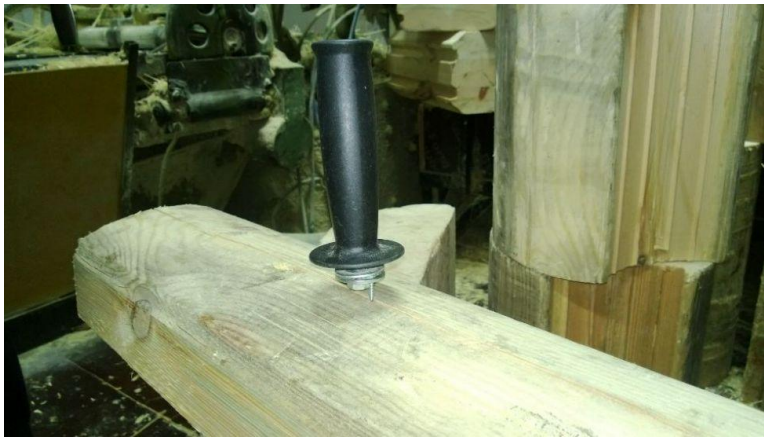
Kuvio 9. Massiivipuun ja hukkapalan siirtämiseen tarkoitettu tartuntapiikki.
