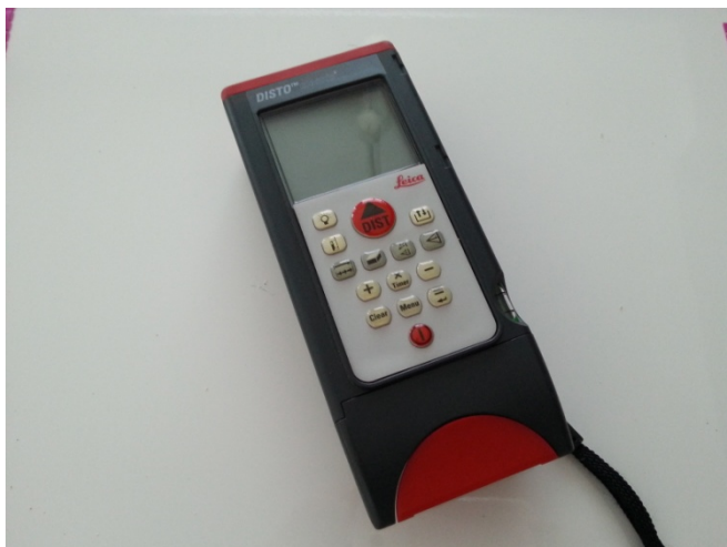
Kuvio 8. Leica Disto™ Classic 5 -etäisyysmittari
