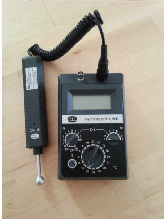
Kuvio 7. GANN hydromette RTU 600 -mittari ja B 50 -kosteusanturi
