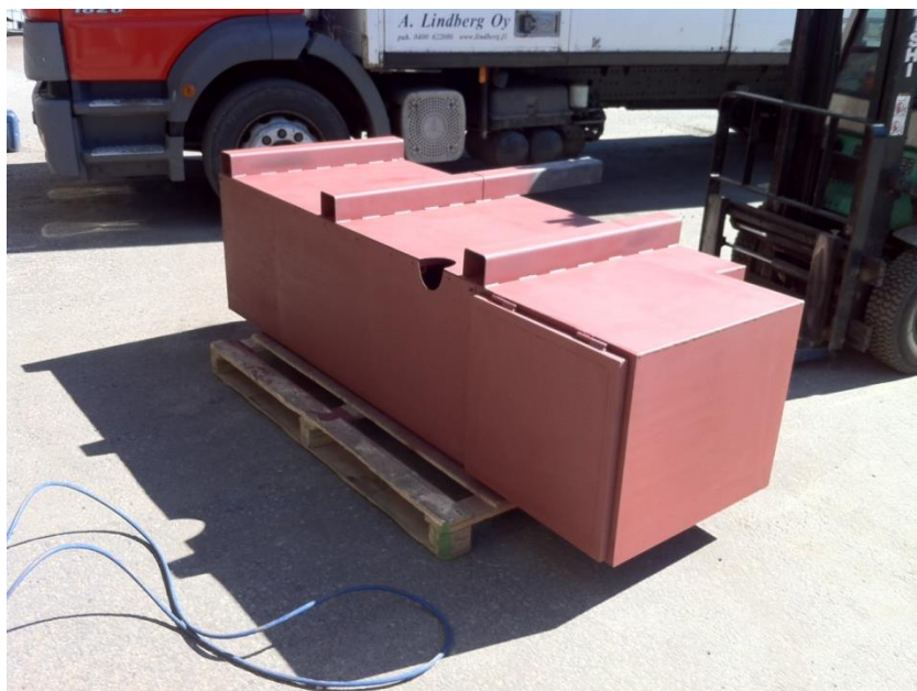
KUVA 7. Pohjamaalattu teräs rakenne. (Kari Tuhkanen 2013.)
