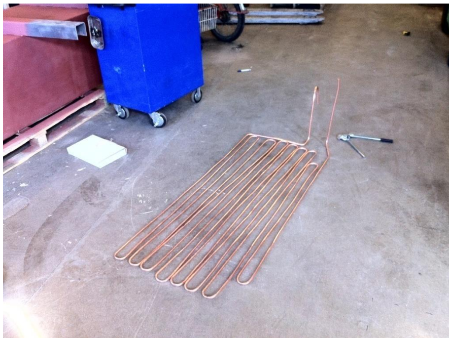
KUVA 2. Lämmönvaihdin asennusvalmiina. (Kari Tuhkanen 2013.)
