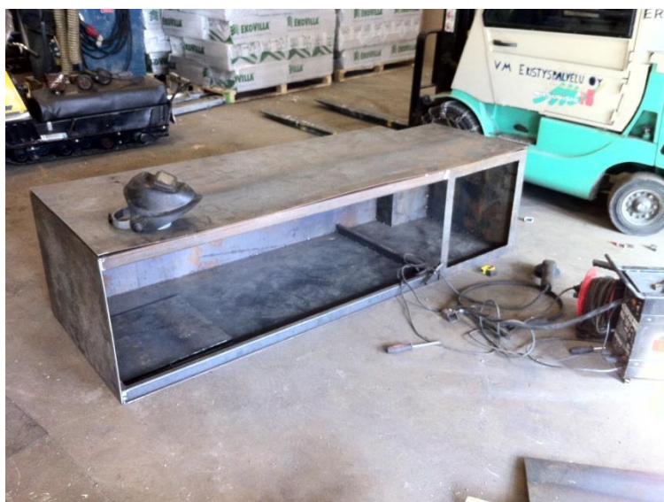
KUVA 4. Säiliön teräsosat sovitettuna toisiinsa. (Kari Tuhkanen 2013.)
