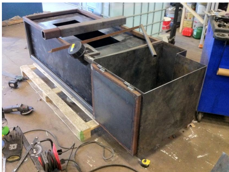
KUVA 5. Liimasäiliön sisäsäiliö koesovituksessa. (Kari Tuhkanen 2013.)
