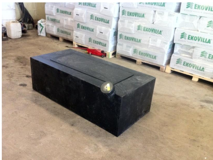
KUVA 6. Polypropeenista valmistettu sisäsäiliö (Kari Tuhkanen 2013.)
