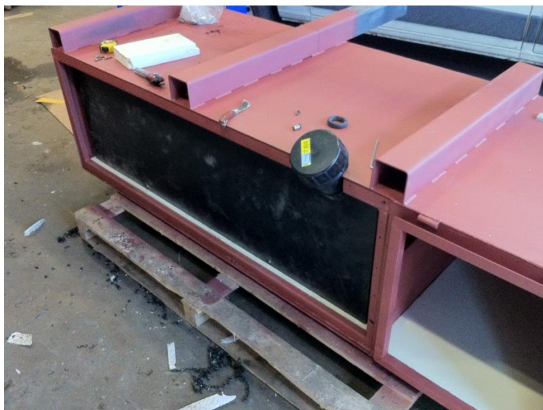
KUVA 1. Säiliön rakenne eliminoi kylmäsiltojen mahdollisuuden. (Kari Tuhkanen 2013.)
