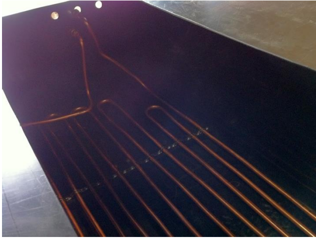
KUVA 8. Lämmönvaihdin asennettuna sisäsäiliöön. (Kari Tuhkanen 2013.)
