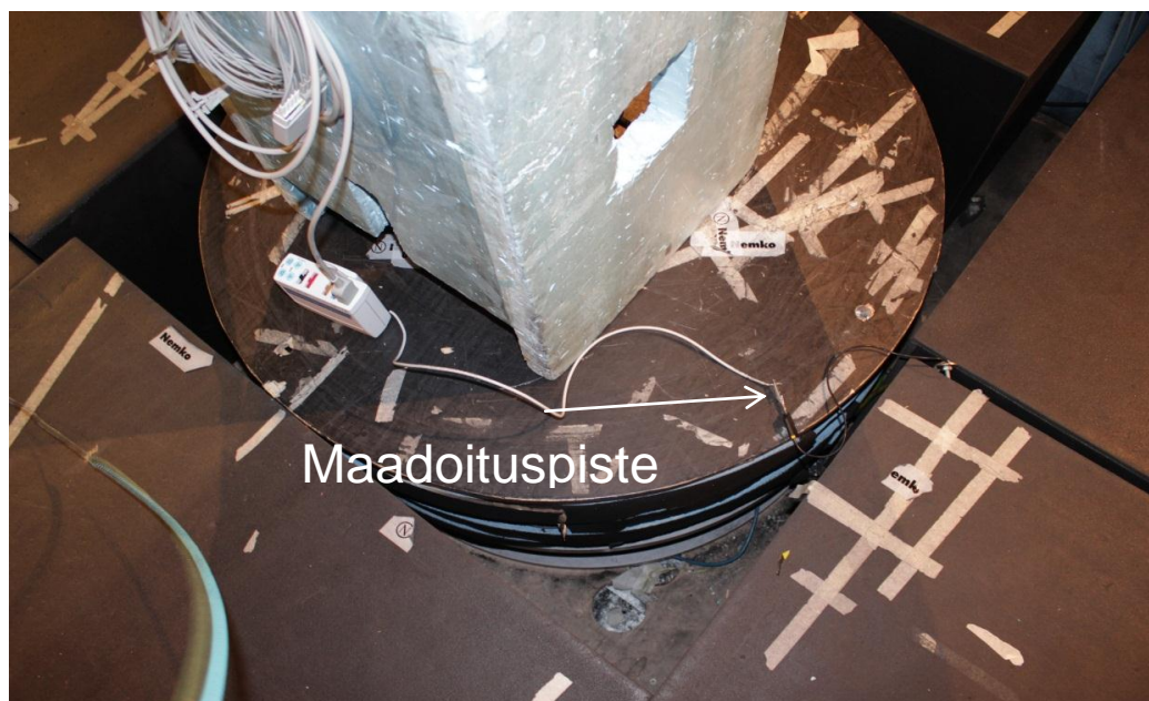
Kuva 8. Moduuli on maadoitettu häiriösietohuoneen maadoituspisteeseen.
