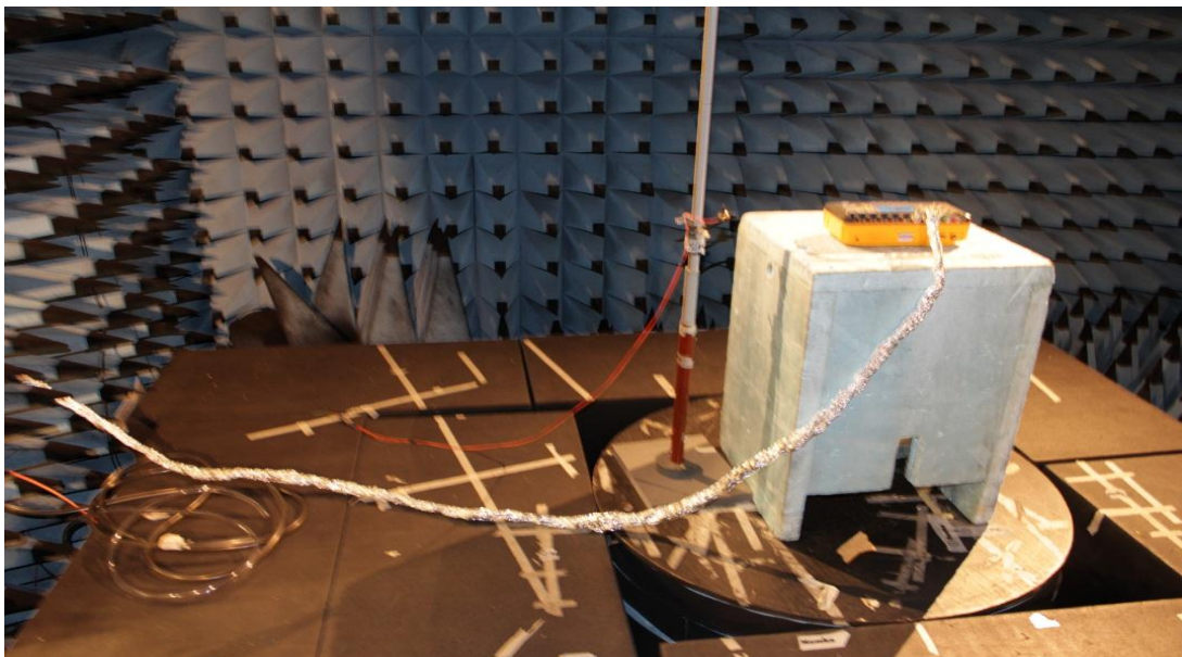
Kuva 3. EKG-simulaattori häiriösietohuoneessa. Johdot on suojattu alumiinifoliolla ja viety seinän läpi monitorille.
