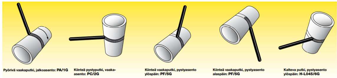
Kuva 7 Putkien päittäisliitoksia [11].
