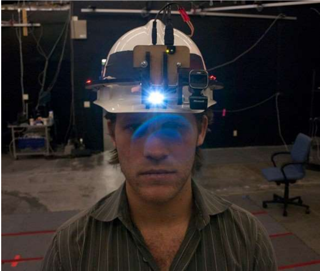
Kuva 21. Päässä pidettävä projektorinäyttö [32].
