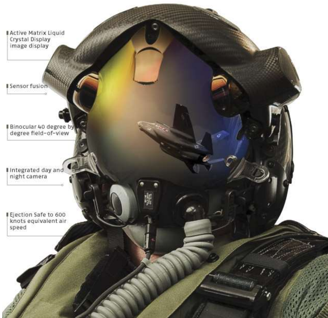
Kuva 5. Lockheed Martin F-35 Lightning II –hävittäjälentokoneen pilotin kypärä [11].
