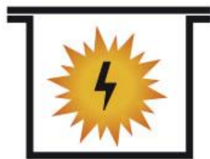
KUVIO 4. Exd-rakenteen periaatekuva (Ensto Oy 2013)
