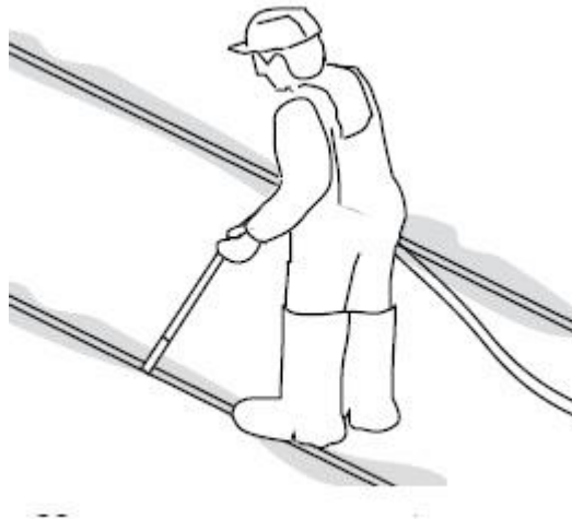
Kuva 21. Ontelolaattojen saumabetonointi (Ratu 0389, 10).
