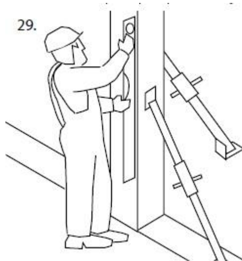
Kuva 22. Pilarin tuenta ja pystysuoruuden tarkistus (Ratu 0391, 9).
