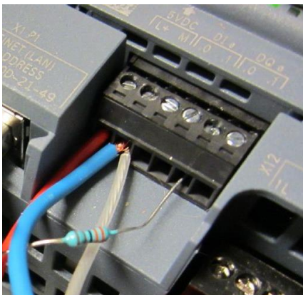
KUVA 7. Vastus kytkettynä signaalimoduulin pulssilähtöön
