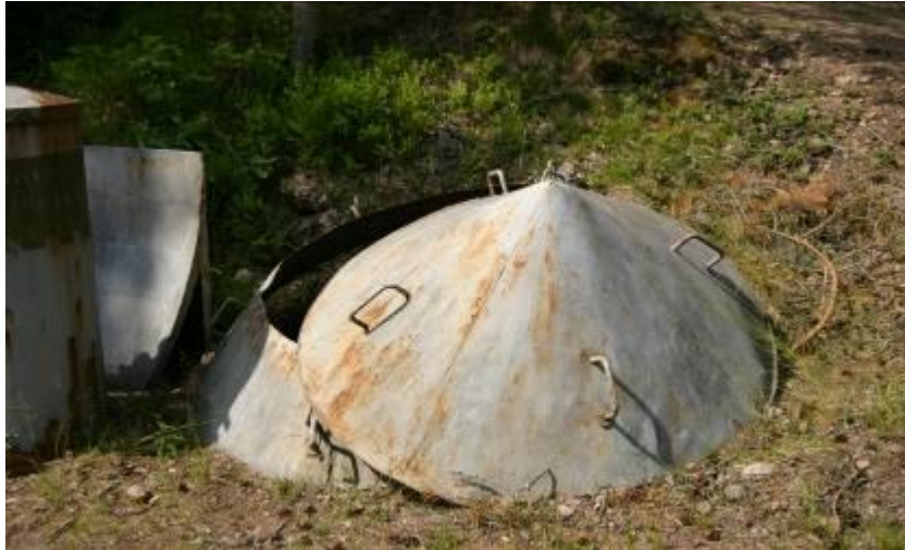
Kuva 21: Muottikalustoa, alamuotti ja valukartio, Salpamuseo Miehikkälä, Kaikkonen 2011
