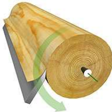
KUVIO 3. Viilumaton sorvauksen periaate (Puuproffa 2008)
