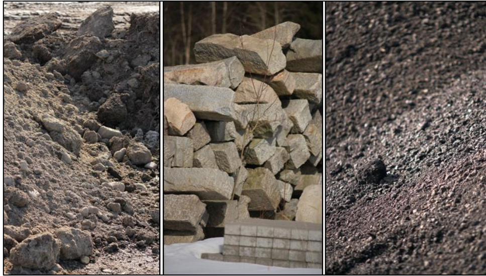
Kuva 11. Materiaaleja uusiokäyttöön: hienoainesta, reunakiviä ja asfalttimurskettä (valokuvat Kirsi Lehtonen).
