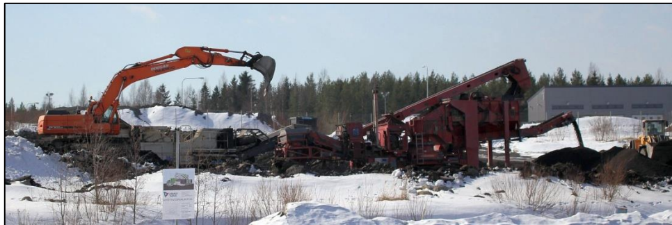
Kuva 22. Asfaltin murskausta Tarastenjärvellä (valokuva Kirsi Lehtonen).
