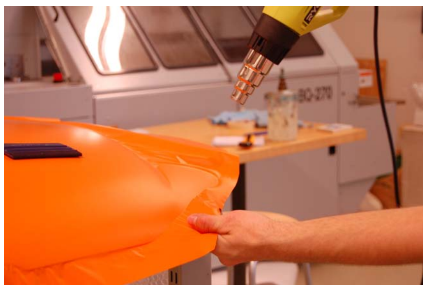
Kuva 25. Teippiä lämmitettiin ja venytettiin kaarevan muodon päälle.
