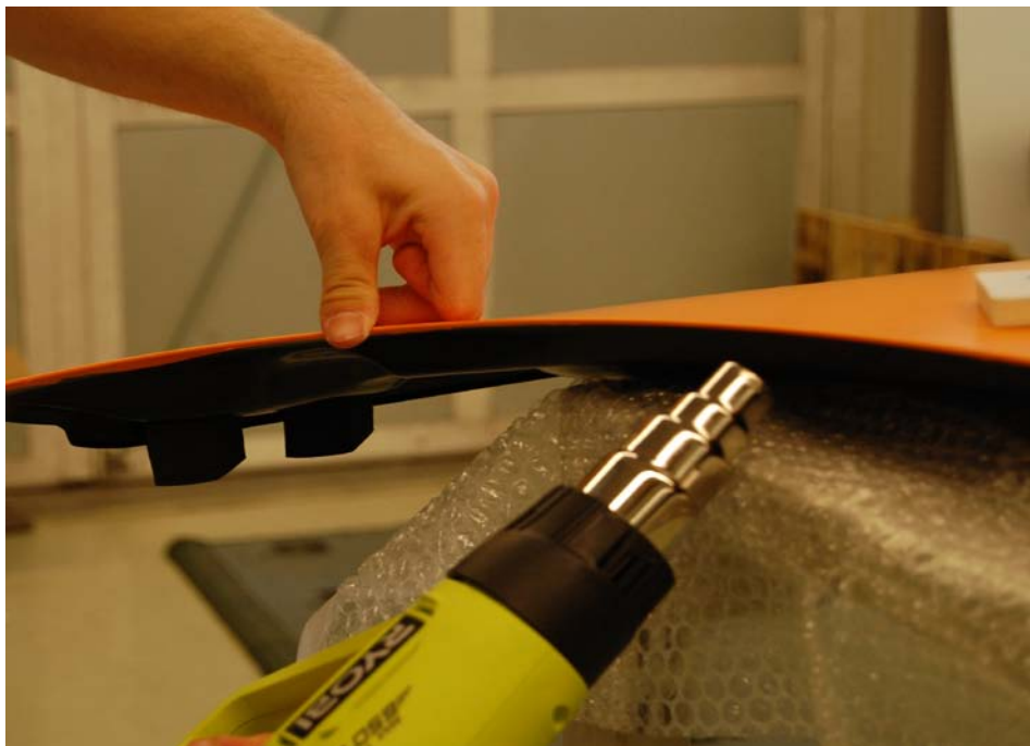
Kuva 28. Reunat ylittävä teippi leikattiin noin 2 cm:n mittaiseksi, käännettiin reunojen alle ja jälkilämmitettiin 90 celsiusasteeseen.
