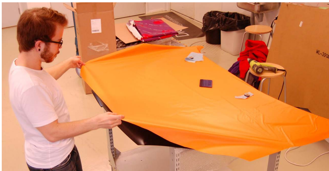
Kuva 24. Liimapinta paljastettiin kokonaan ja aseteltiin konepellin päälle.
