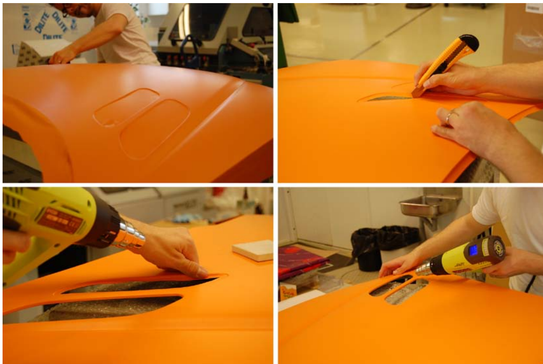
Kuva 27. Ilmanottoaukkojen leikkaaminen esiin ja teippausten kääntö reunojen alle.
