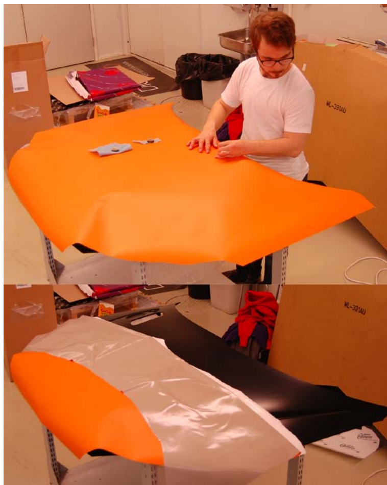
Kuva 22. Teipin asemointi ja liimapinnan paljastus.
