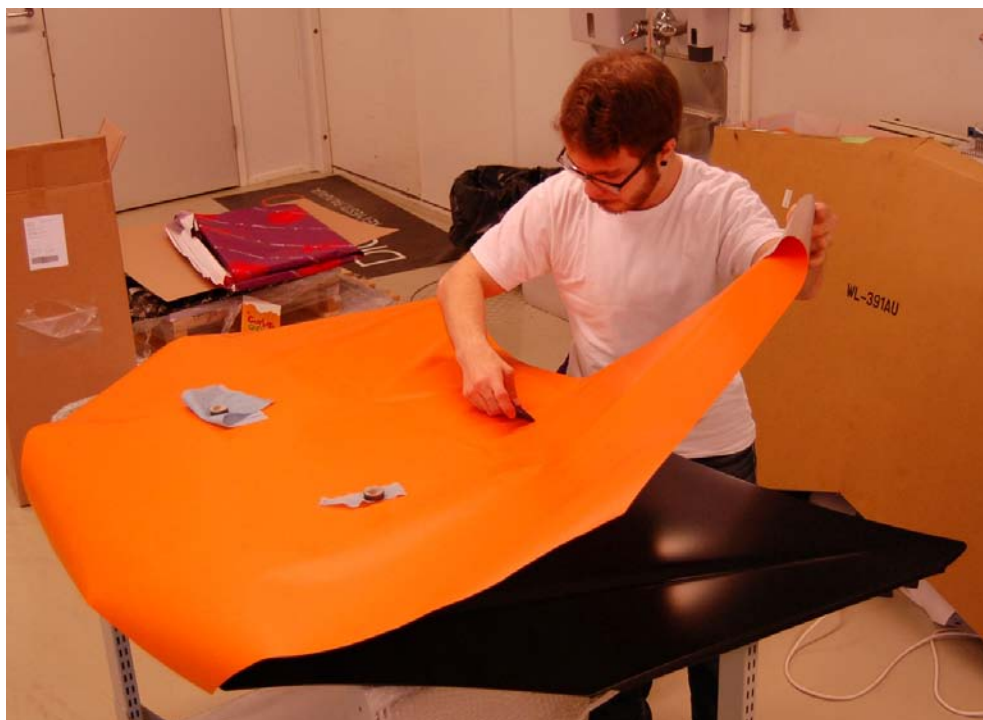
Kuva 23. Teippiä lastoitettiin keskeltä reunoja kohti.
