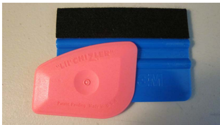
Kuva 16. Teipin asennukseen käytettäviä lastoja [23, s.2].
