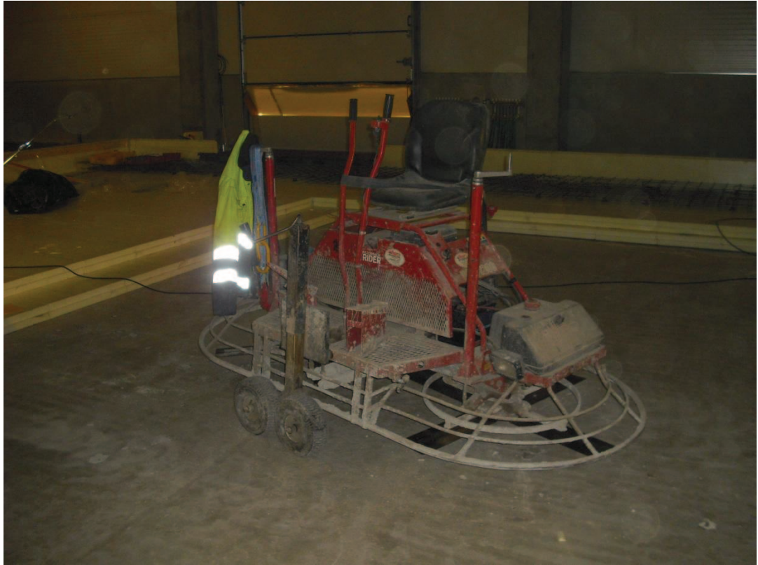
Kuva 13. Teräsiivekehiertoon tarkoitettu päältäajettava hiertokone. (Kuva: Raul Korolainen 2013.)
