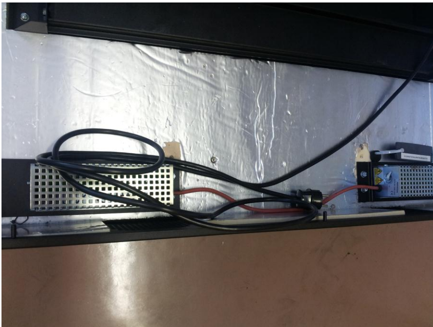
KUVA 28. Muokatun näyttökotelon siirretyt lämmityselementit
