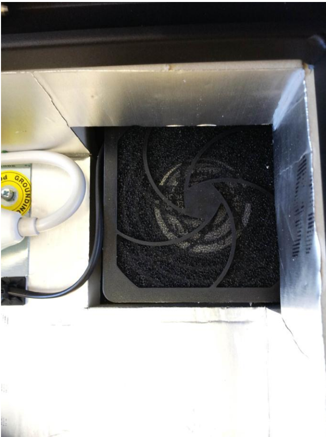
KUVA 19. Kotelon korvausilmaa ottava tuuletinsuodatin
