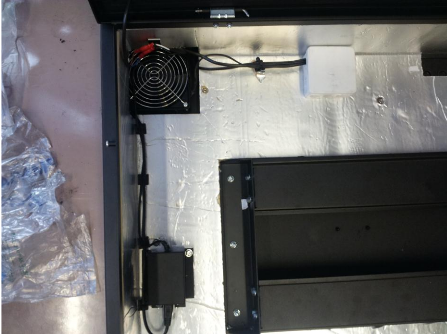
KUVA 29. Muokattu näyttökotelo, termostaatit siirretty pois
