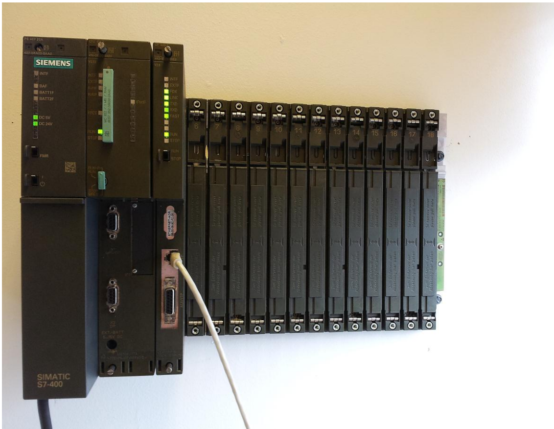
KUVA 36. Testilogiikka, Siemens S7-400
