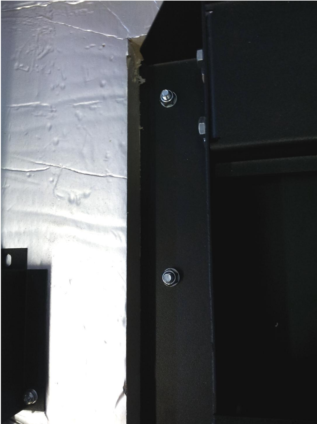
KUVA 21. Kotelon sisäpuolen eristekerros
