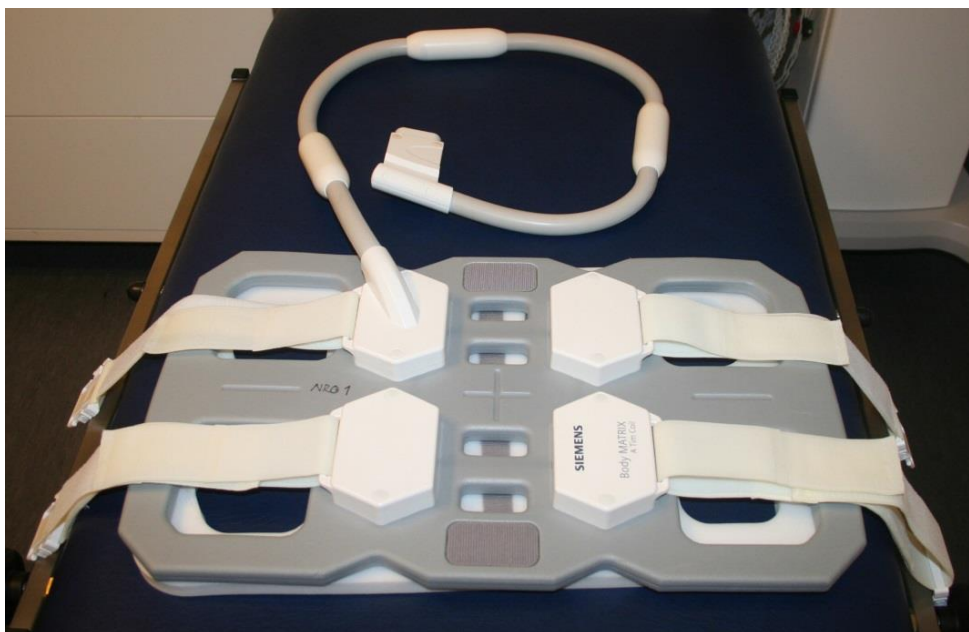
KUVA 3. RF-kela vartalon alueen magneettikuvantamista varten (Honkanen 2013-09-06.)
