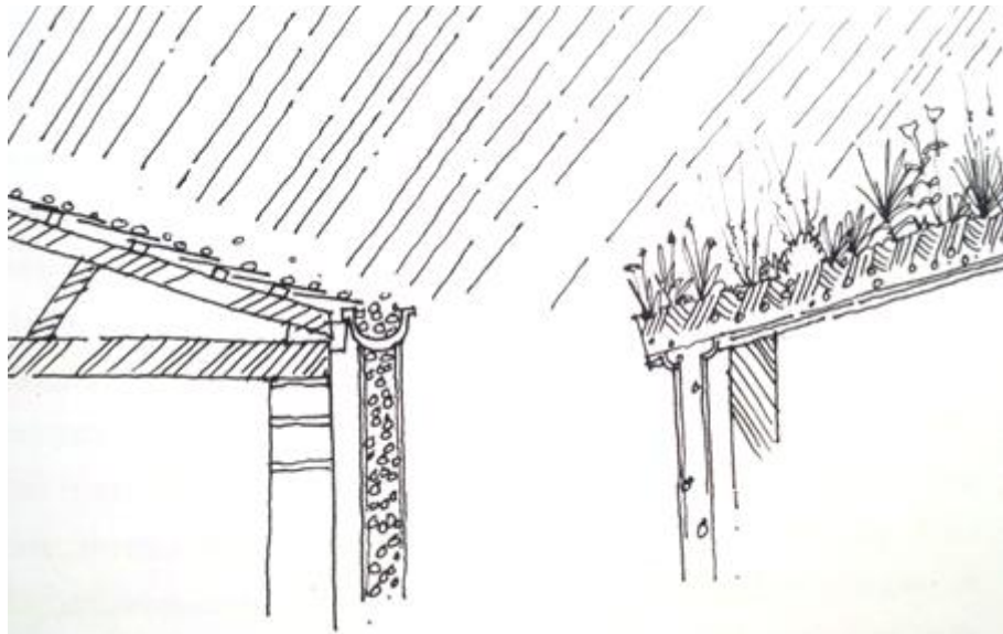
Kuva 2. Viherkattoon imeytyy huomattava määrä sadevettä, mikä hidastaa ja vähentää sadeveden katolta valuvaa vesimäärää. Andy Claydenin piirros teoksessa Dunnet & Kingsbury 2008, 55.
