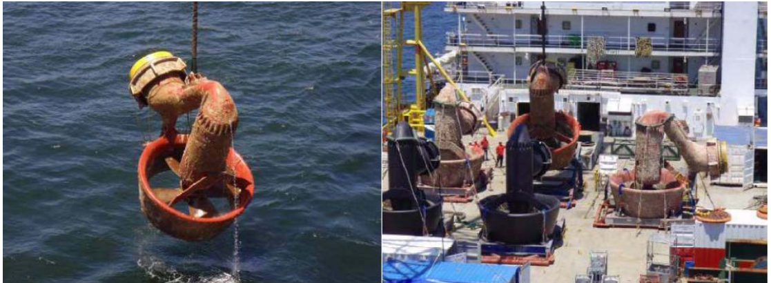
Kuva 21 Porauslautan propulsioyksikön vaihto määräaikaishuoltoa varten (Varis & Laakkonen 2011, muokattu)
