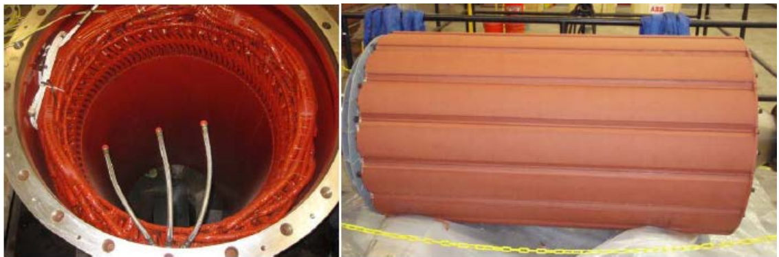
Kuva 24. Compact -mallin staattori purettuna (Varis & Laakkonen 2011)
