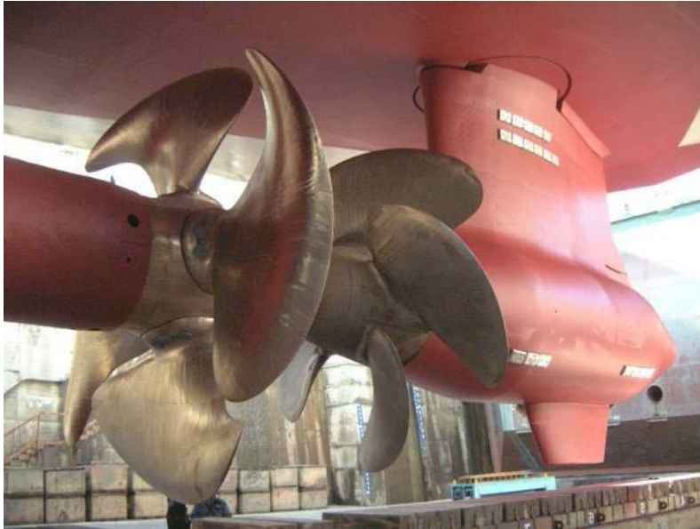
Kuva 31 Ropax -aluksen CRP - potkurijärjestely (JBU 2010)
