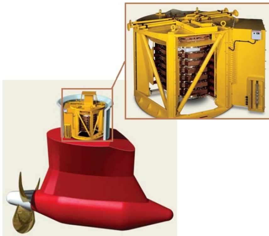
Kuva 6. Azipodin pääliukurengasyksikkö (Cavotec; Marine Propulsion Sliprings 2007, muokattu)
