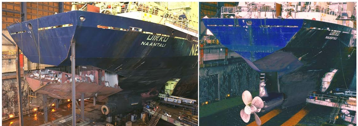
Kuva 12. MT Uikun propulsiokoneiston vaihto Azipodiin (ABB Development of the Azipod System, muokattu)
