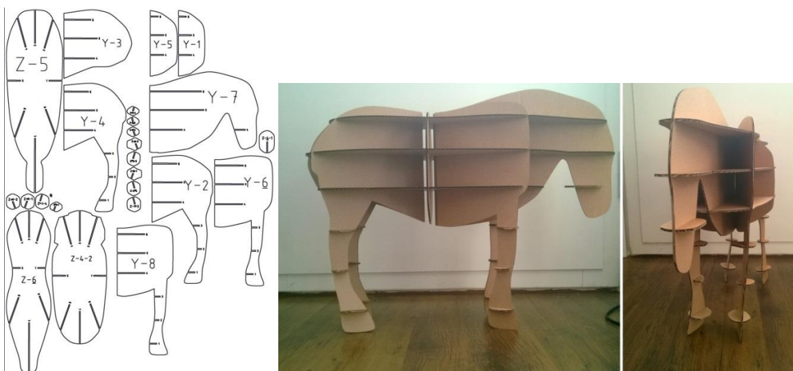
Kuva 26: Ensimmäiset vektoripiirrustukset mallin leikkaamiseen. Kuva 27: Ensimmäin koottu malli
