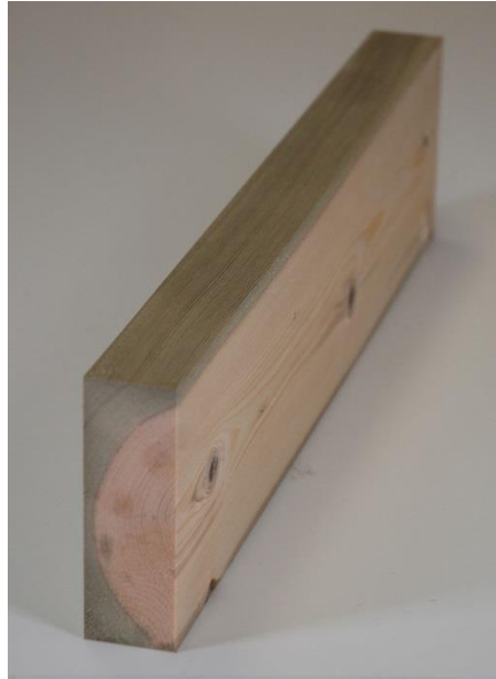
Kuva 7: Suoja-aineet ovat värjänneet männyn pintapuun tummaksi. Sydänpuuhun ne eivät ole imeytyneet.
