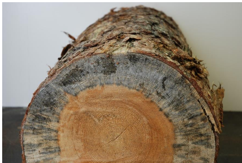
Kuva 6: Sinistäjäsienen aiheuttama puun värjäytyminen ja männyn sydänpuu, johon sinistäjäsieni ei ole pystynyt.
