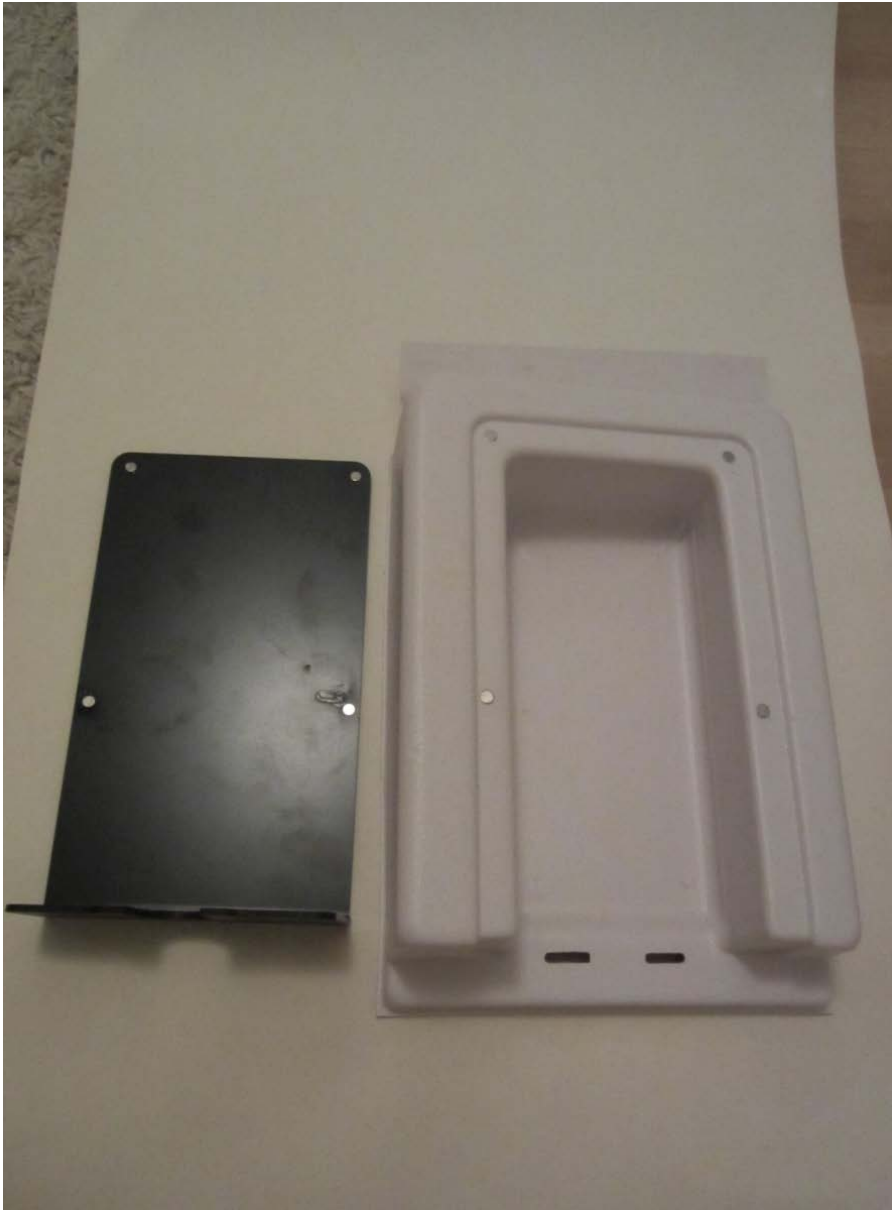
Valmis muuntajakotelo magneettikiinnityksellä
