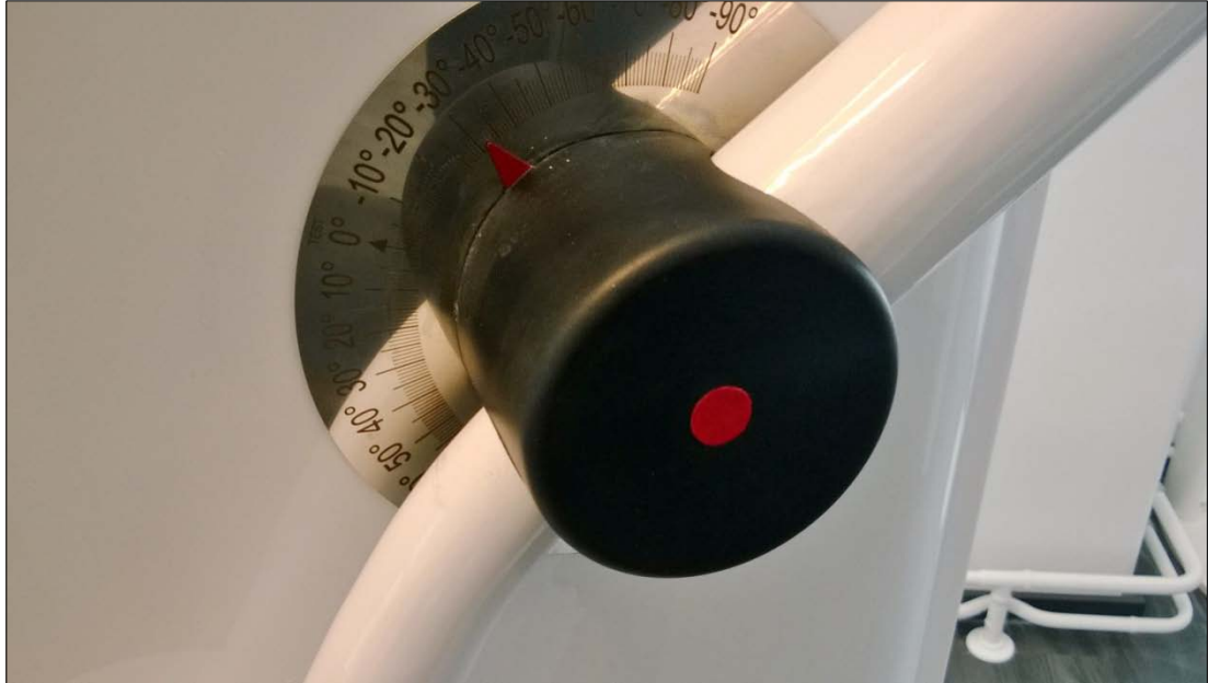
Kuva 36. Liikevarren navansuojan ja asteikkolevyn tuotantoversiot. (Parviainen 2013)
