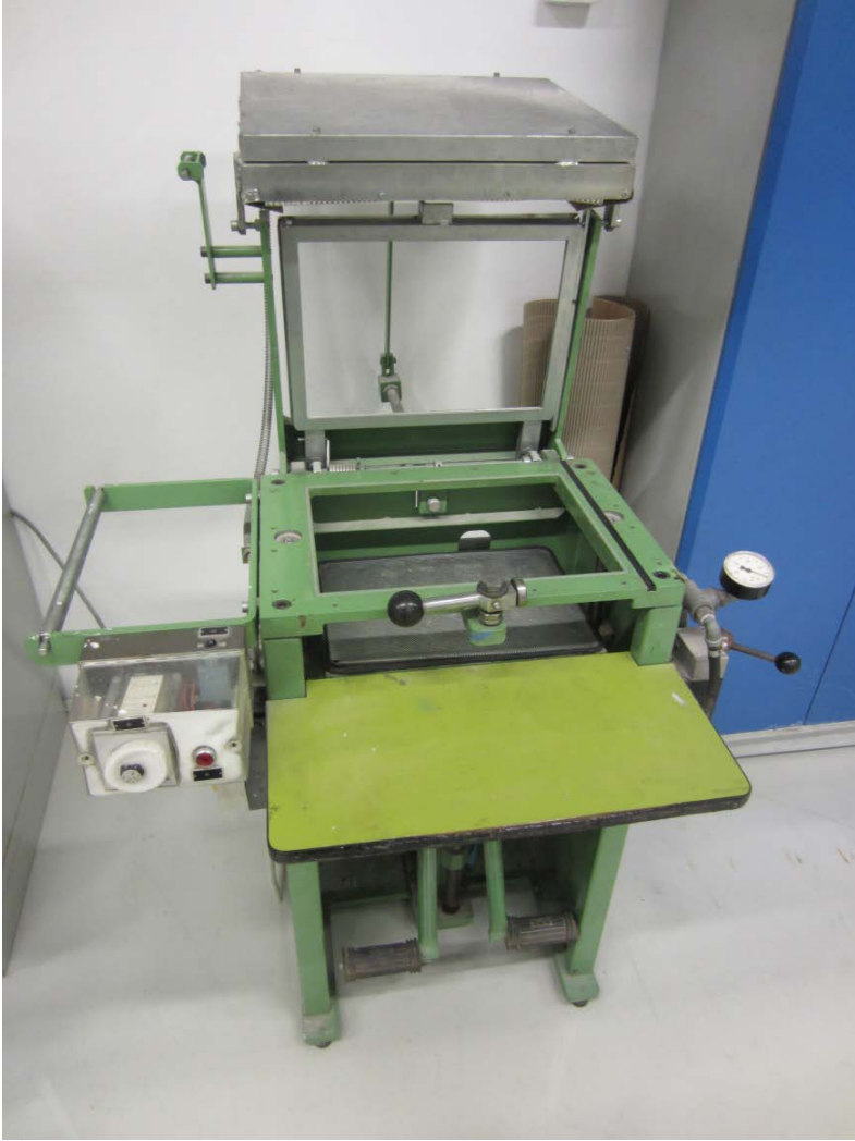
Tyhjiömuovauskone, jolla protomalli valmistettiin
