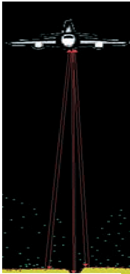
Kuvio 3. Laserkeilauksen käyttö ojan syvyyden ja kunnan arvioinnissa. (Arbonaut 2009).
