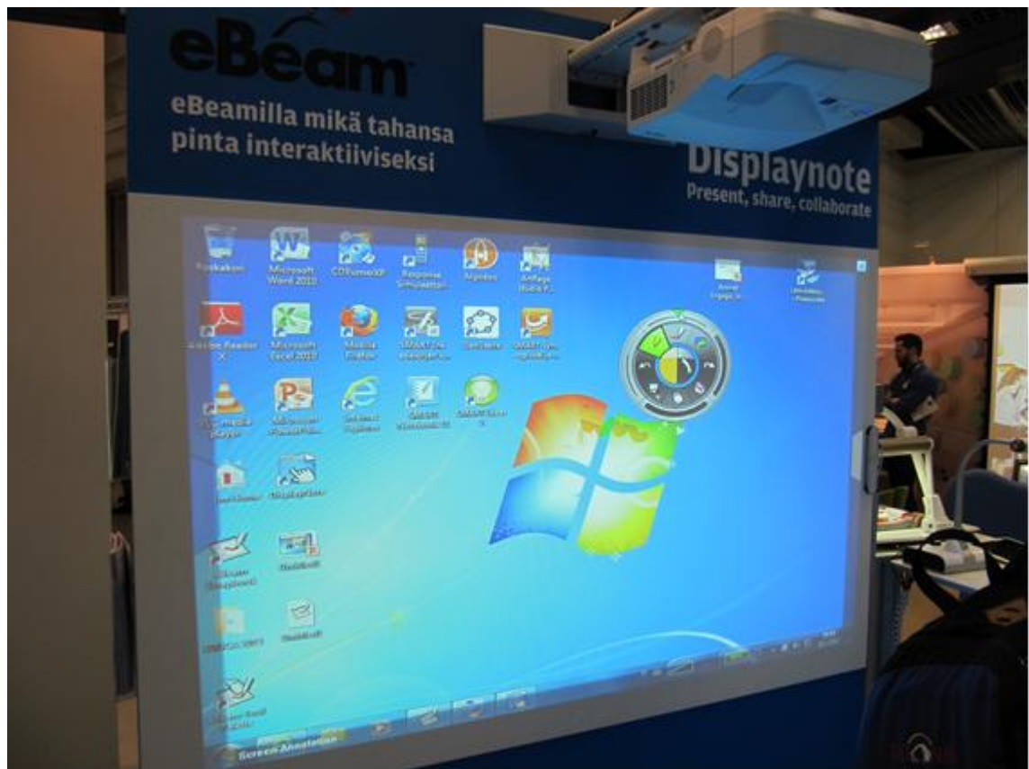
Kuva 5.1 Lisälaite eBeam edge tekee projektorin heijastamasta pinnasta interaktiivisen. Kuva Antti Loisa, Educa -messut 26.1.2013.
