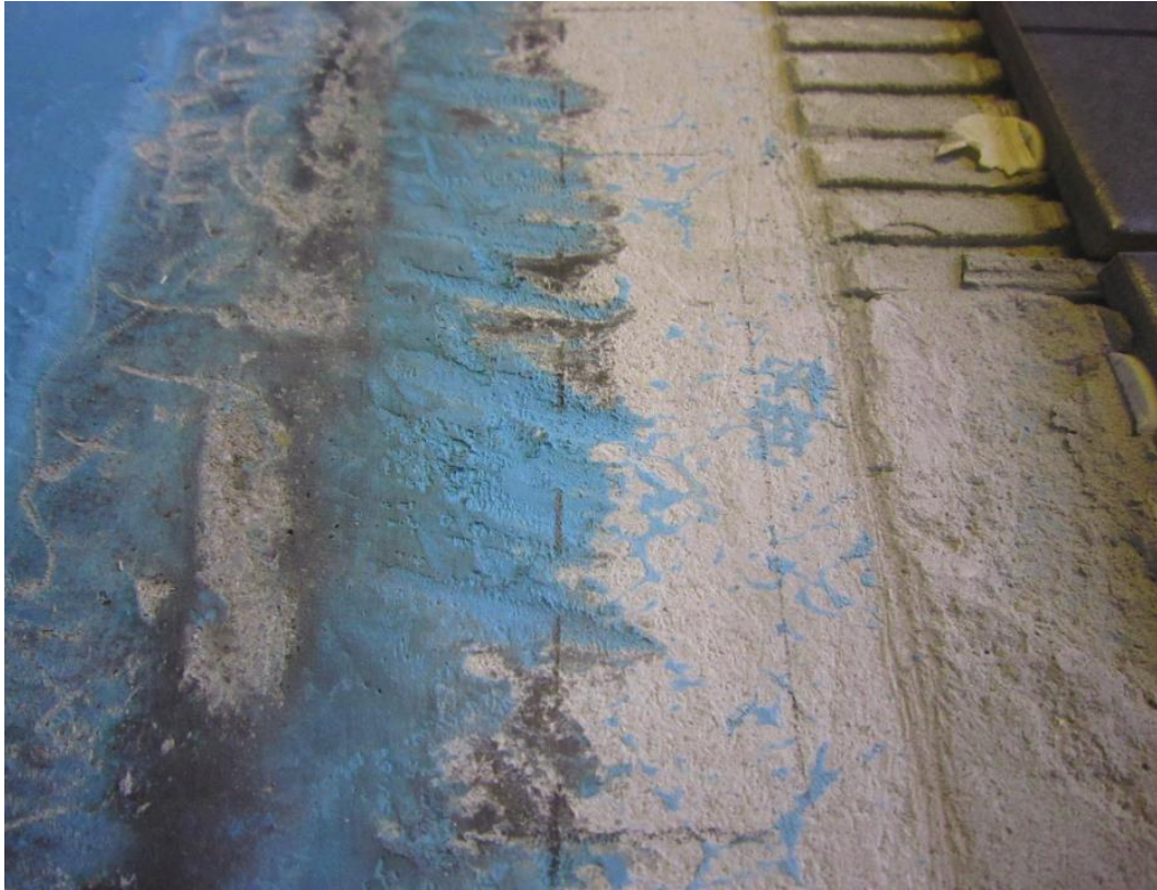
Kuva 40. Yleiskuvaa kokeen järjestelystä, osakorjausmallit. Puhdistamaton mallikappale. Laastipinta on hiottu koneellisesti, korjauskohdan rajapinta.
