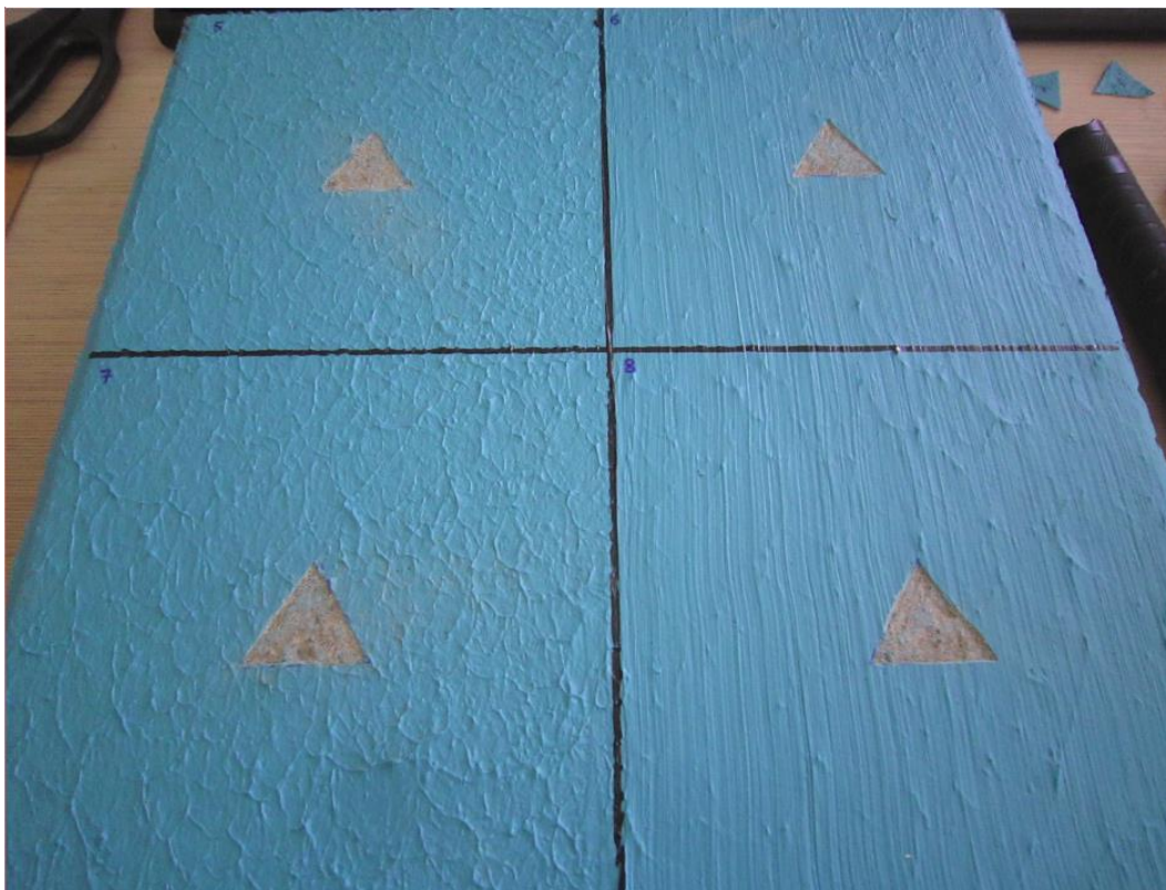
Kuva 8. Yleiskuvaa kokeen järjestelystä. Vedeneristyksen valvontatyössä leikattavan aukon paikkausmalli. Aukot on leikattu.
