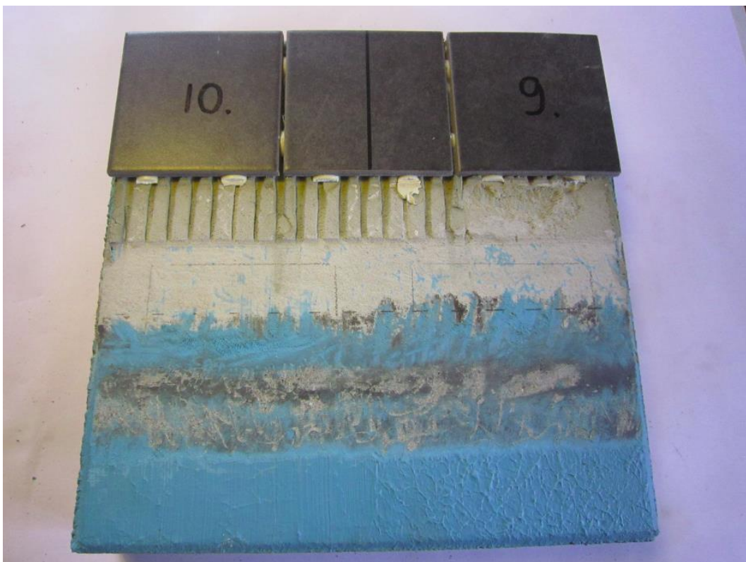
Kuva 39. Yleiskuvaa kokeen järjestelystä, osakorjausmallit. Puhdistamaton mallikappale. Laas- tipinta on hiottu koneellisesti, ei puhdistettu käsin ollenkaan.
