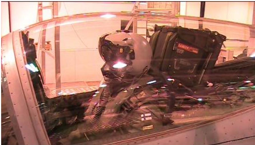
KUVA 13. Kypärän kalibrointi / Neutraali istuma-asento (Satakunnan lennosto 2013)
