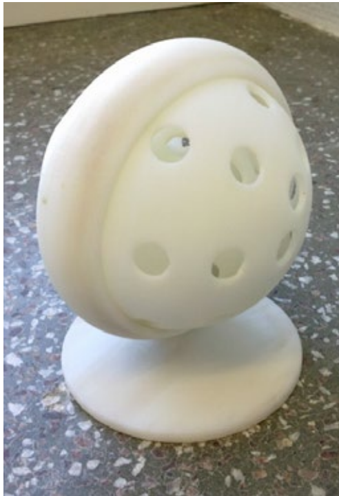
Kuva 5. Esimerkkituloste, joka muodostuu useista sisäkkäisistä palloista, jotka ovat samanlaisesti tulostettu
