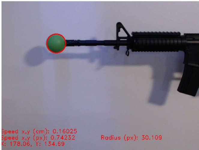
KUVA 10. Bittimaskin tiedoista jatkojalostetut sijaintitiedot liitettyinä alkuperäiseen kuvaan.
