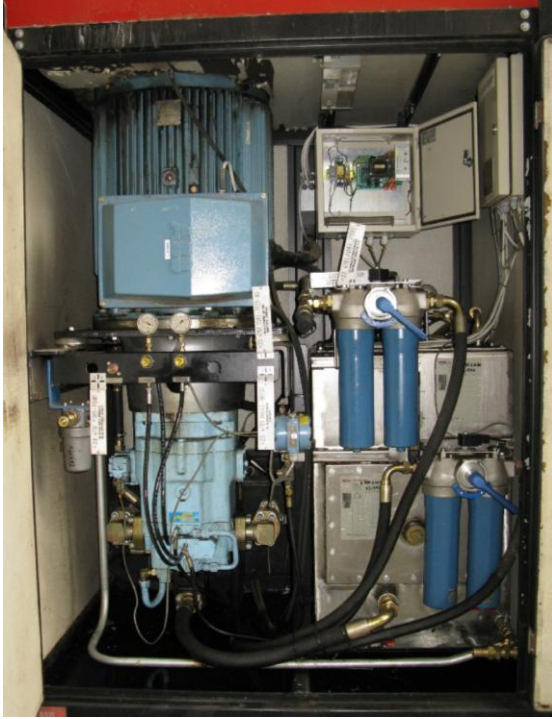
Kuva 3.3 Hägglunds Denison-hydraulikoneikko, joka käyttää nestemoottoreita
