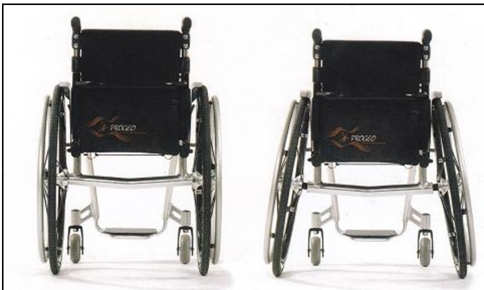
KUVA 14. Pyörätuolin camber-kulma. Vasemmalla tuolilla ei ole camber-kulmaa. Oikean tuolin camber-kulma on 5 astetta. (Invalidiliitto 2009, 12.)
