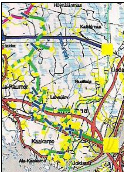
Kuva 8. Isohaaran sähköaseman johtolähtö. (Tornionlaakson Sähkö Oy)
