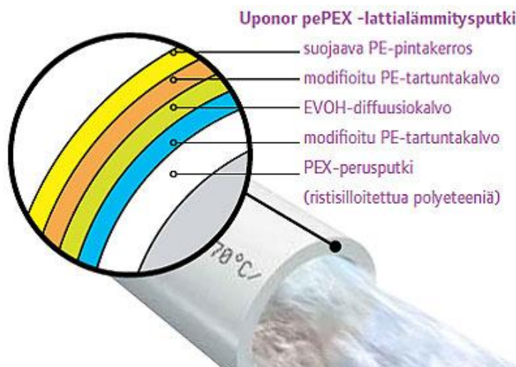
Kuva 9. Uponor Wisho-pePEX putken rakenne [9]
